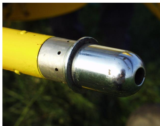
Slika 4.8. Pitot cijev na helikopteru [8]
