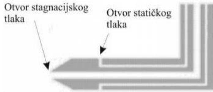
Slika 4.4. Pitotova cijev mjeri stagnacijski i statički tlak [4]
