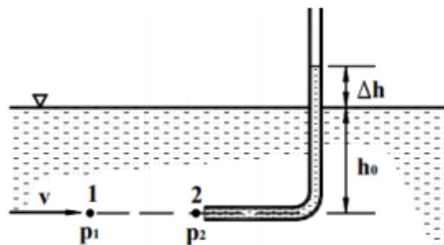
Slika 4.3. Princip mjerjenja brzine fluida pomoću jednostavne Pitotove cijevi [4]
