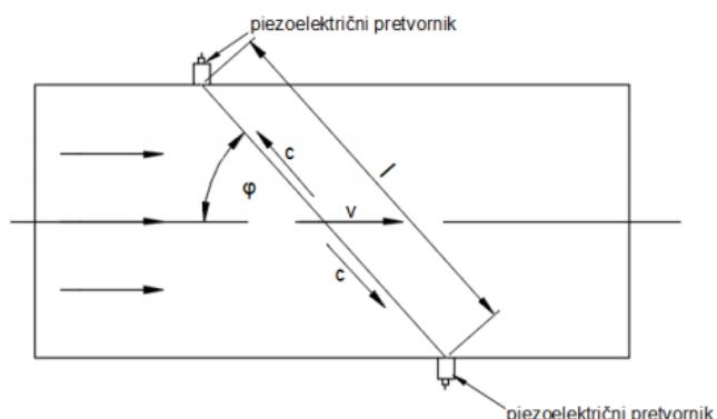
Slika 3.4. Piezoelektrični pretvornici [5]
