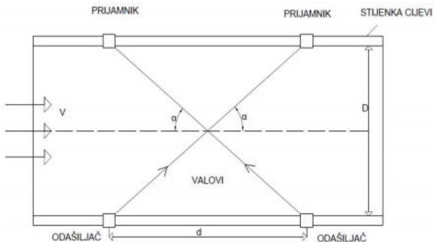
Slika 3.1. Prikaz rada ultrazvučnog mjernog pretvarača protoka [5]
