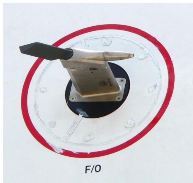
Slika 4.5. Pitotova cijev na zrakoplovu [8]
