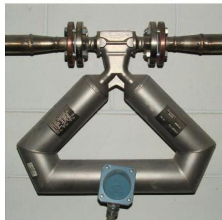
*Slika 2.6. Coriolisov protokomjer [2]*
