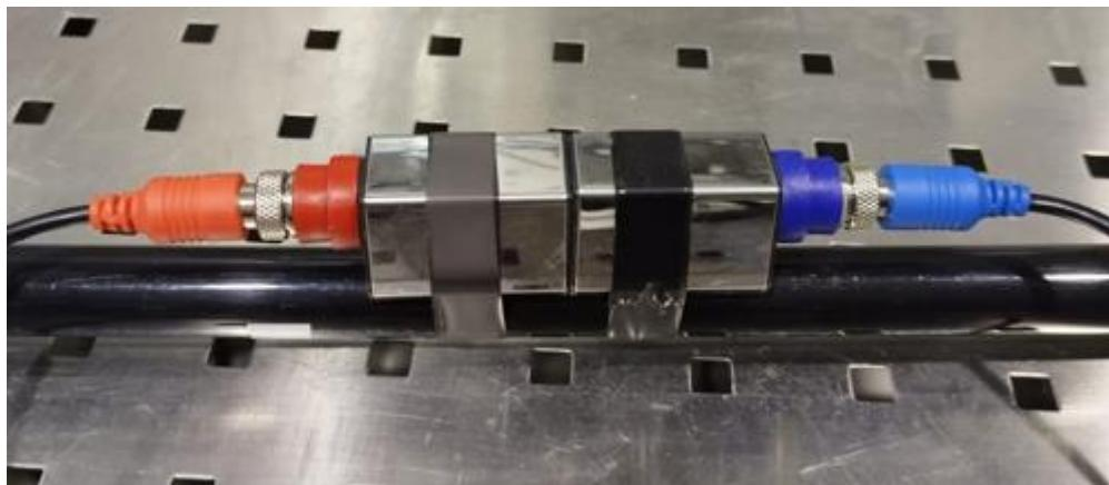
Slika 5.7. Pravilno postavljeni pretvarači na PVC cijev
