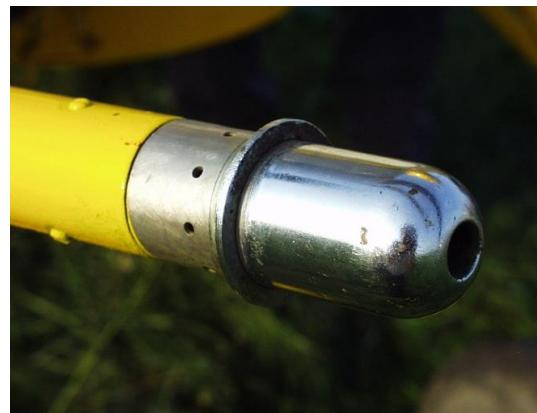
Slika 4.8. Pitot cijev na helikopteru [8]
