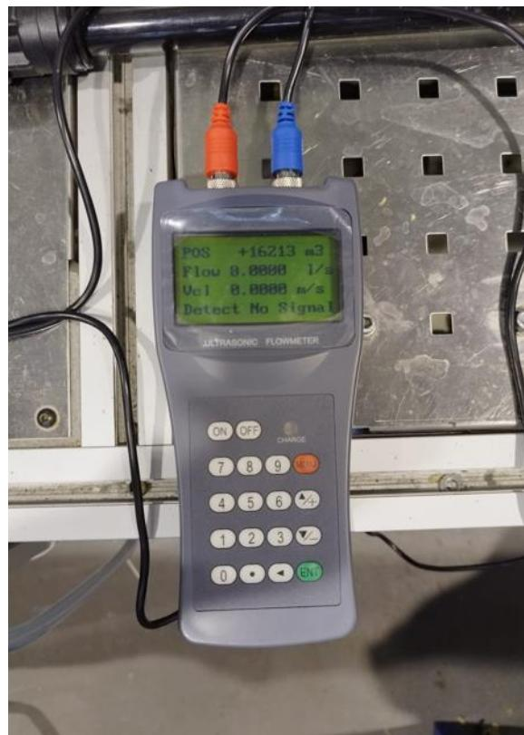
Slika 5.1. Ultrazvučni mjerač protoka
