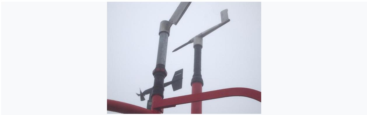
*Slika 4.9. Pitotov statički anemometar [8]*
