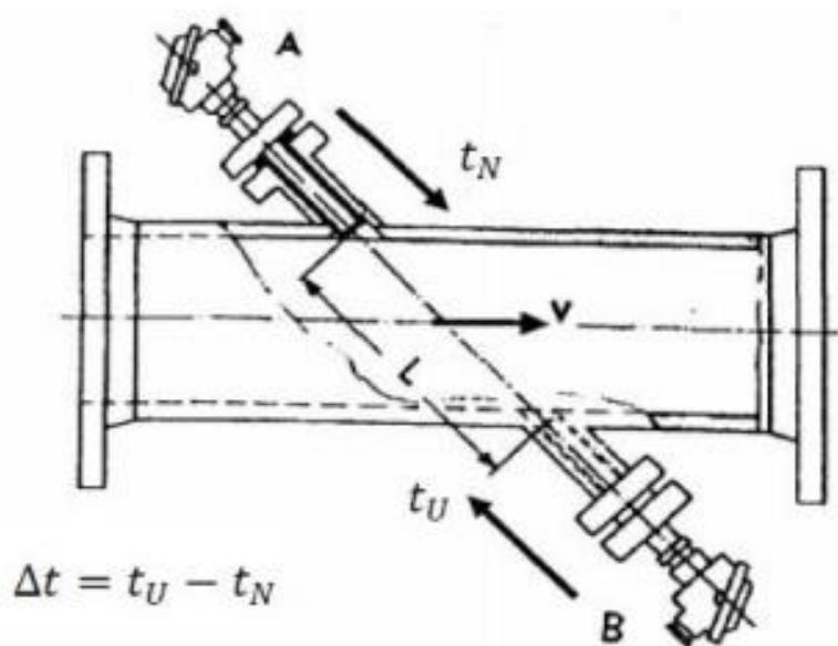
Slika 3.3. Ultrazvučni protokomjer vremena prolaza [7]
