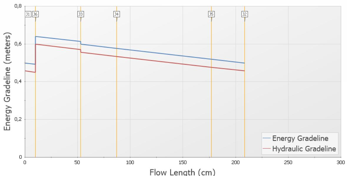
Slika 6.7. Usporedba energetskog i hidrauličkog razreda po dužini cijevi
