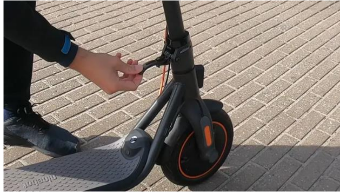
Slika 2.11.1. Stup upravljača sa sklopivim mehanizmom [18]
