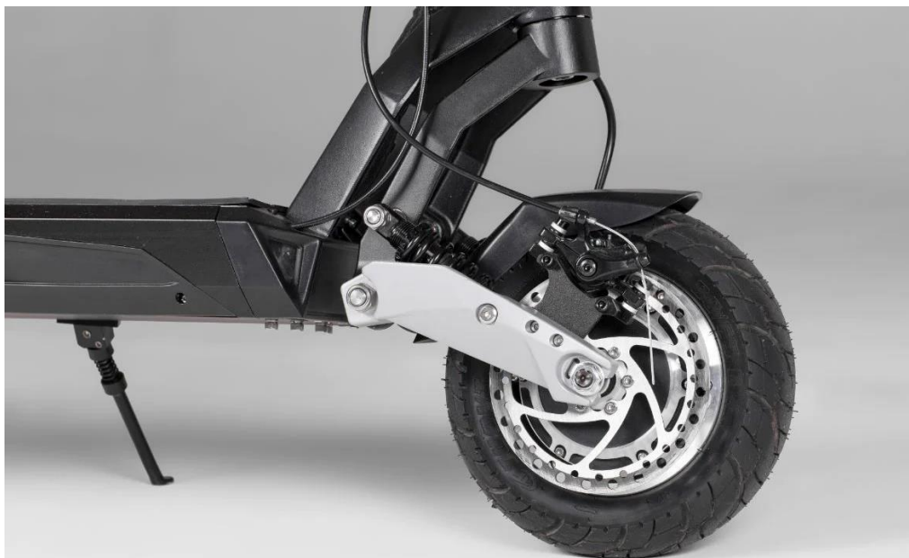
Slika 2.4.1. Disk kočnice električnog romobila [11]
