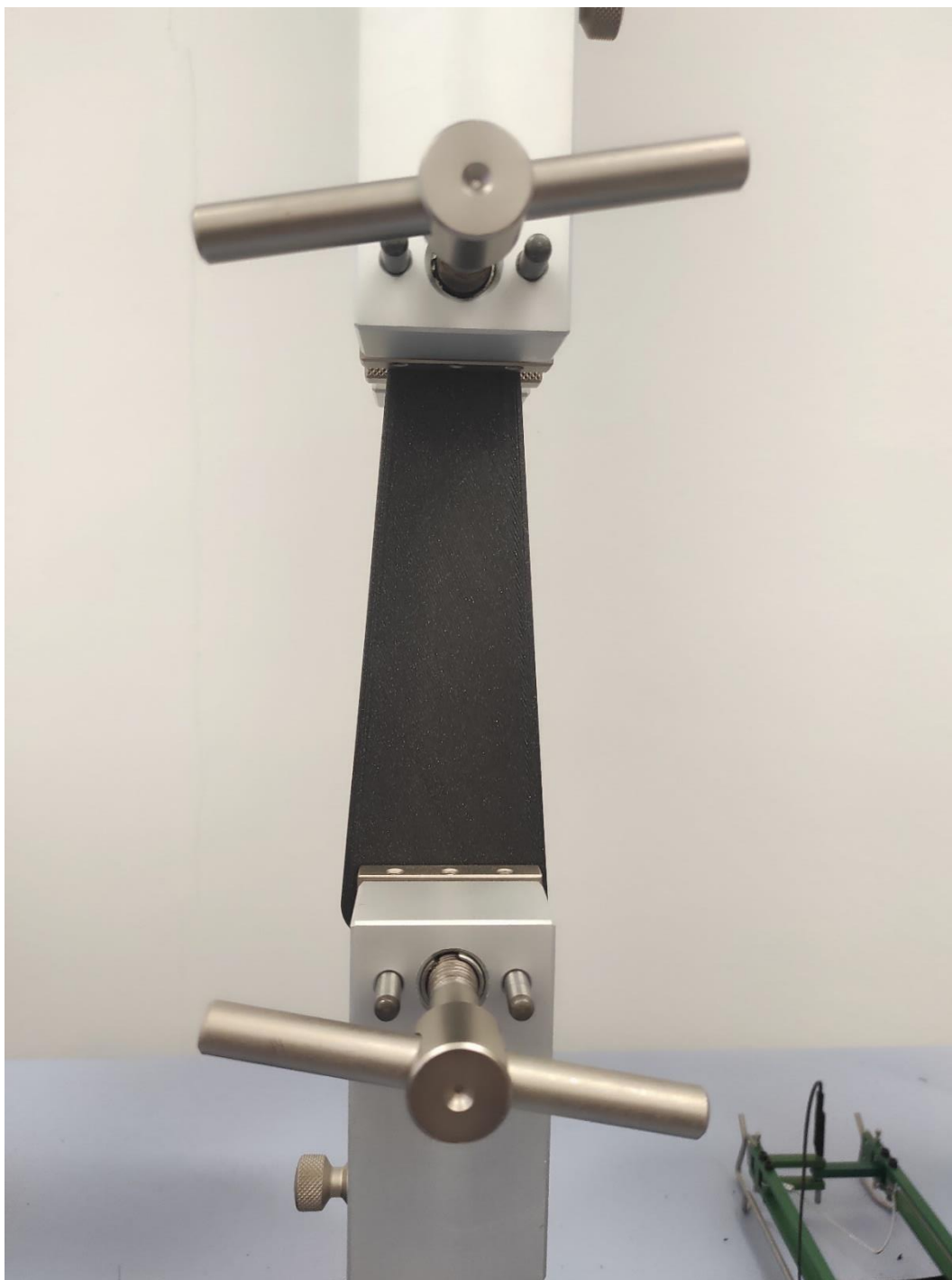
Slika 5.4.2. Ispitivanje na kidalici
