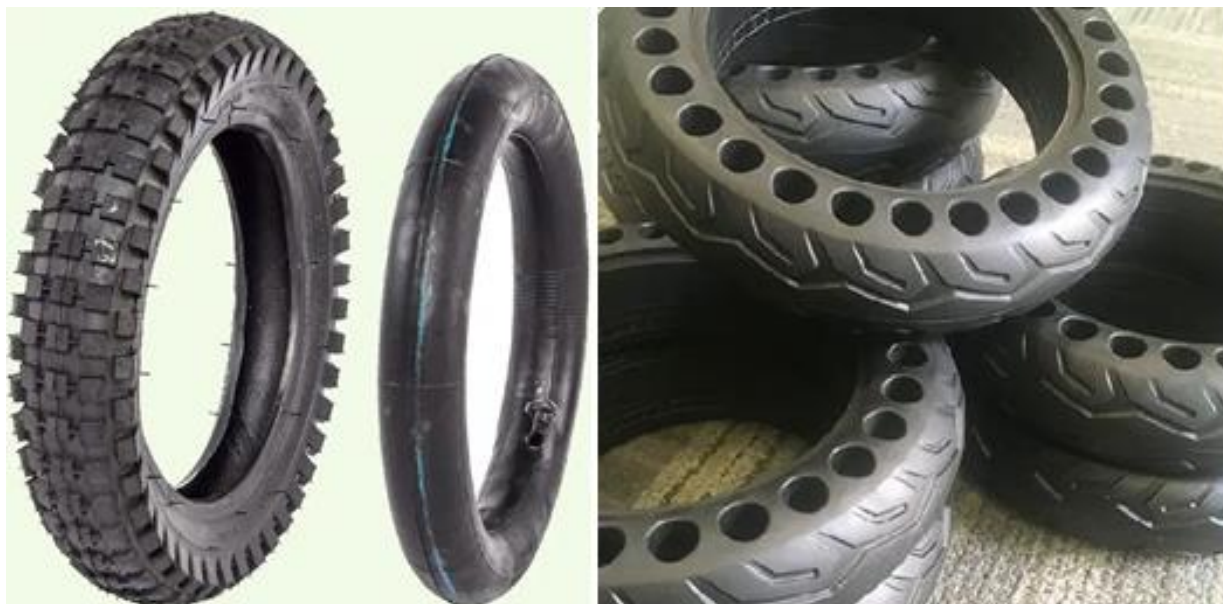
Slika 2.5.1. Pneumatske (lijevo) i pune (desno) gume [12]
