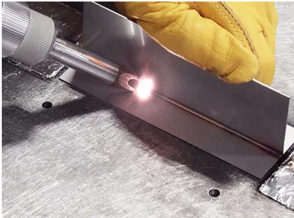
Slika 3.1. Lasersko zavarivanje tankostjenih ploča od aluminija [8]
