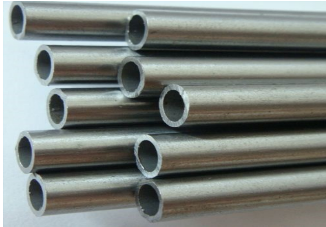
Slika 3.3. Cijevi izrađene od P92 materijala [9]
