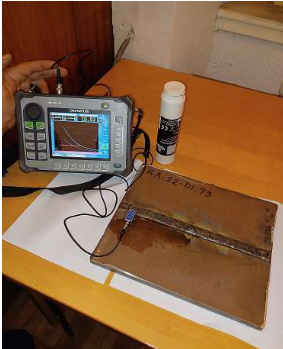
Slika 4.10. Ultrazvučno ispitivanje strojnog dijela RA.22-DI.73
