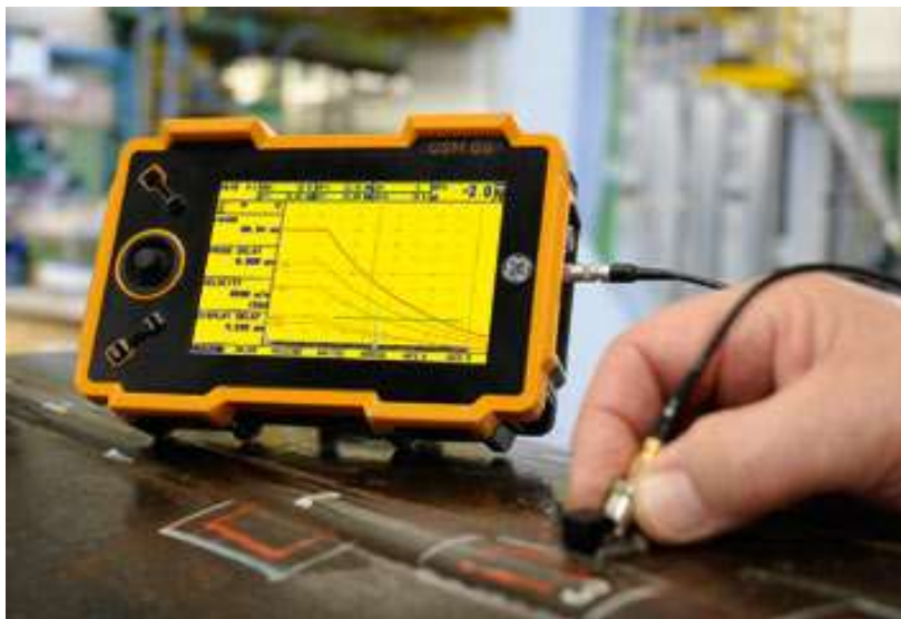
Slika 3.13. Oprema za ispitivanje ultrazvukom [17]
