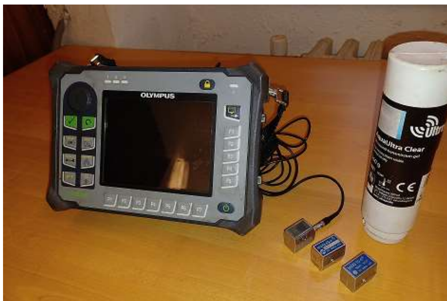
Slika 4.9. Ultrazvučni aparat OLIMPUS EPOCH 650
