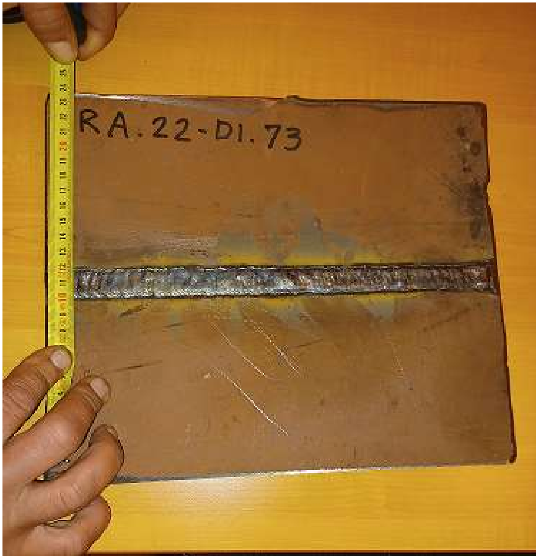
Slika 4.2. Mjerenje dimenzija zavara (širine) metrom
