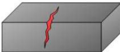
Slika 3.8. Uklanjanje viška penetranta s površine
