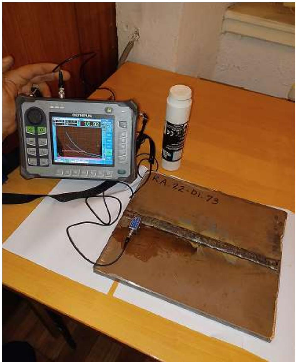
Slika 4.10. Ultrazvučno ispitivanje strojnog dijela RA.22-DI.73
