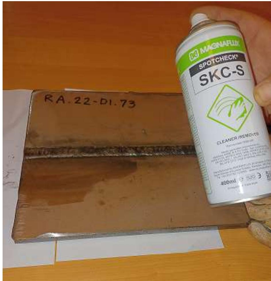
Slika 4.5. Čišćenje ispitne površine
