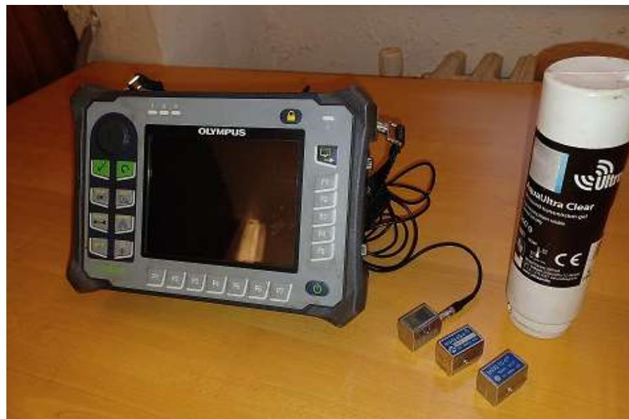
*Slika 4.9. Ultrazvučni aparat OLIMPUS EPOCH 650*
