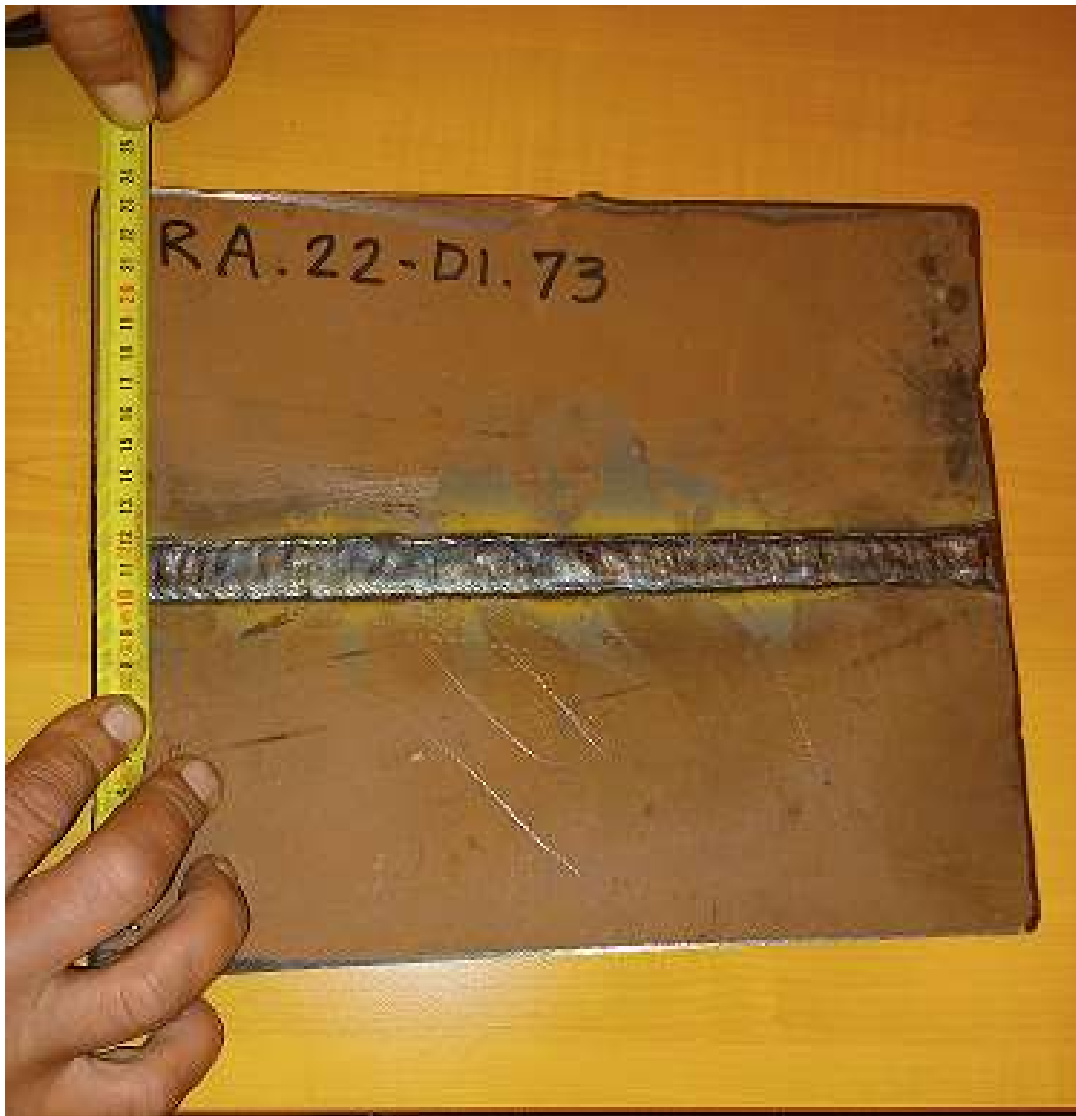
Slika 4.2. Mjerenje dimenzija zavara (širine) metrom
