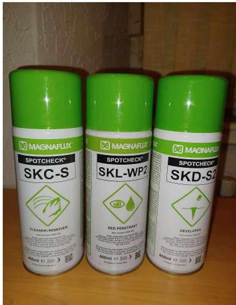
Slika 4.4. Čistač, crveni penetrant i razvijač
