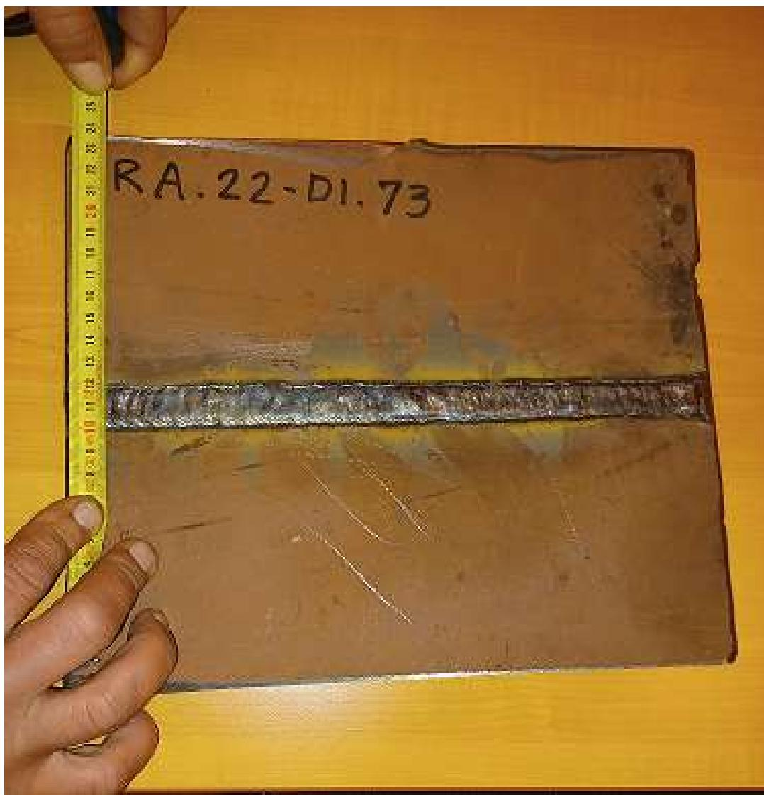
Slika 4.2. Mjerenje dimenzija zavara (širine) metrom
