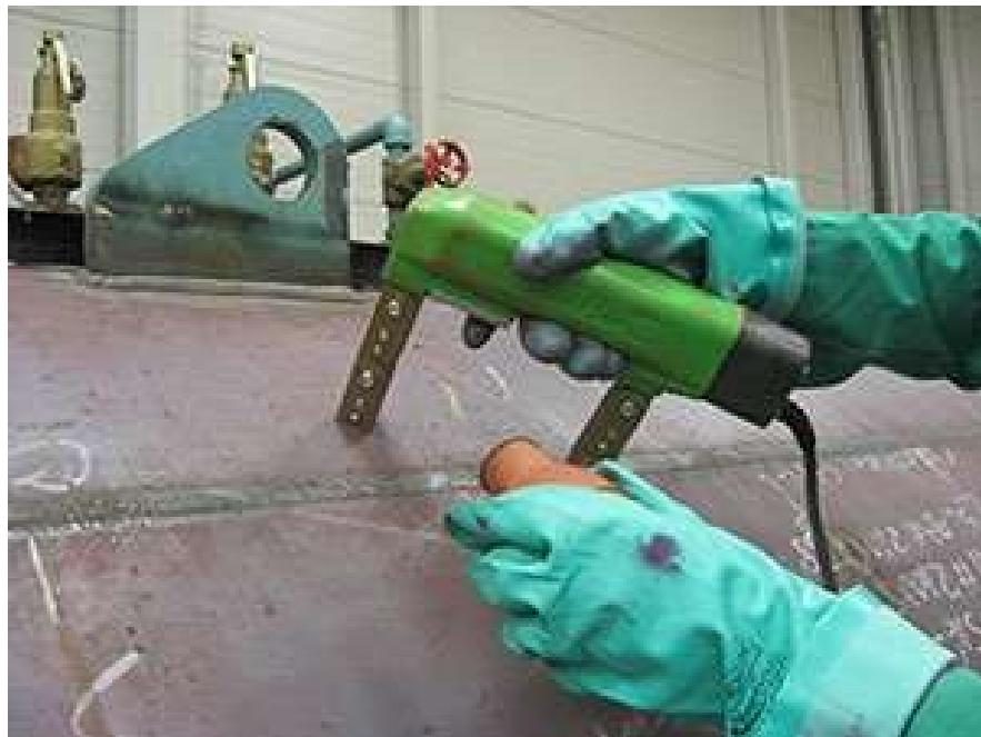
Slika 3.12. Ispitivanje zavarenog spoja magnetskim jarmom [16]
