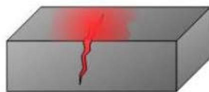
Slika 3.7. Nanošenje penetranta
