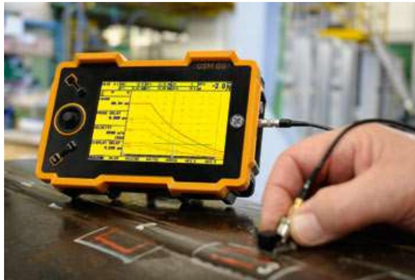
Slika 3.13. Oprema za ispitivanje ultrazvukom [17]
