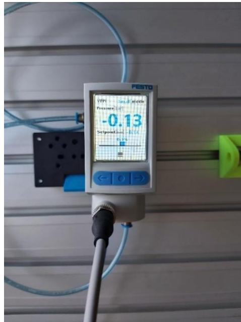
Slika 5.2 Proporcionalni regulator tlaka VPPI-5L-3-G18-1V1H-V1-S1D
