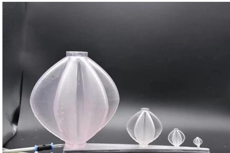
Slika 2.4 GRACE pneumatski aktuator [8]
