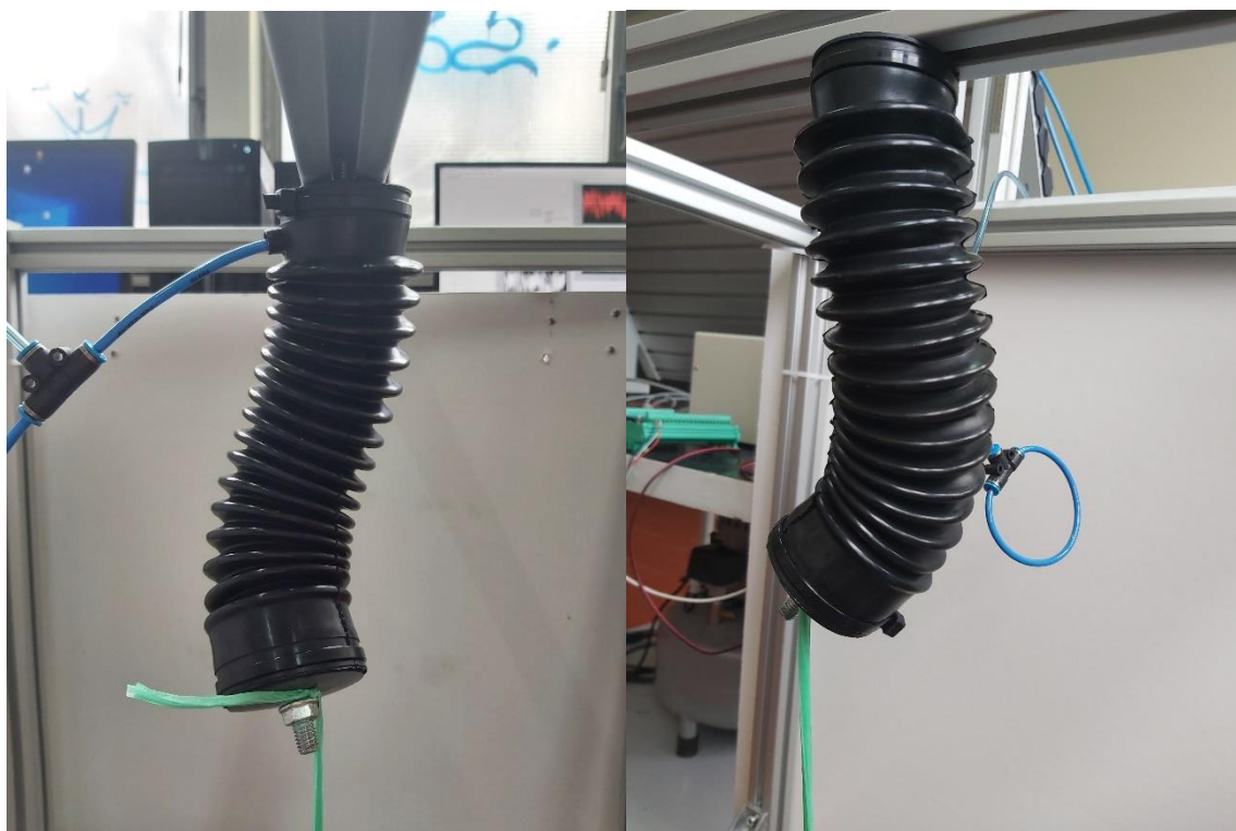
Slika 6.5 Prikaz izvijanja pneumatskog mišića
