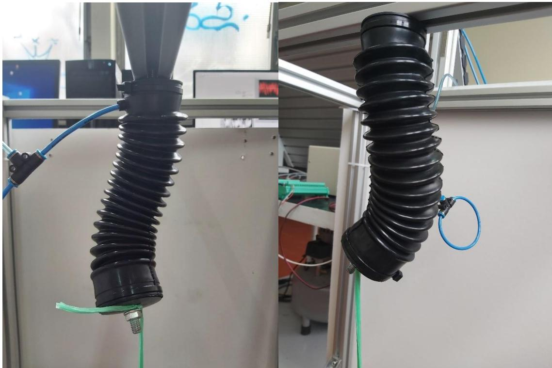
*Slika 6.5 Prikaz izvijanja pneumatskog mišića*
