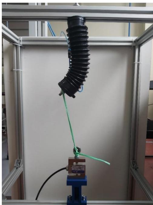
Slika 6.4 Mjerenje sile za kutni pomak od  $30^\circ$
