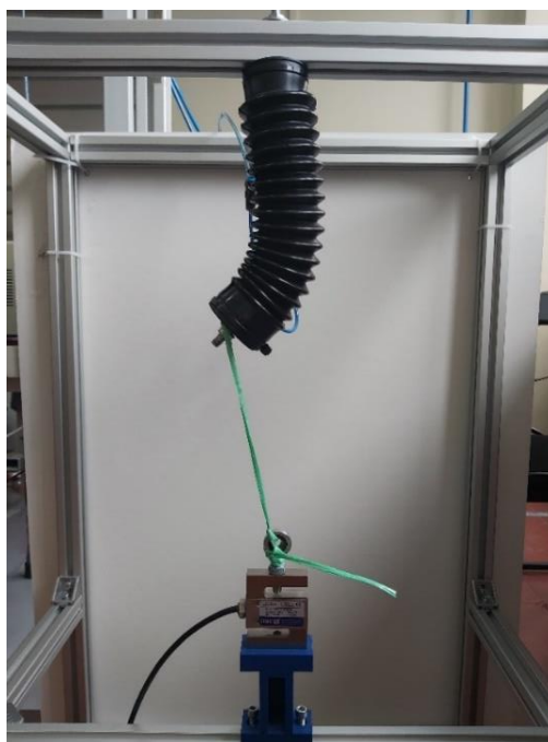
Slika 6.4 Mjerenje sile za kutni pomak od 30°
