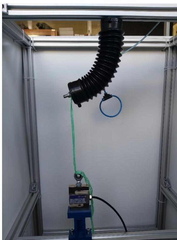
Slika 6.8 Mjerenje sile za kutni pomak od  $90^\circ$
