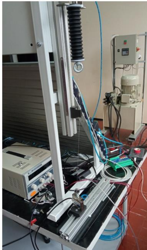
Slika 4.3 Prikaz montaže mišića i povezanosti sa senzorom
