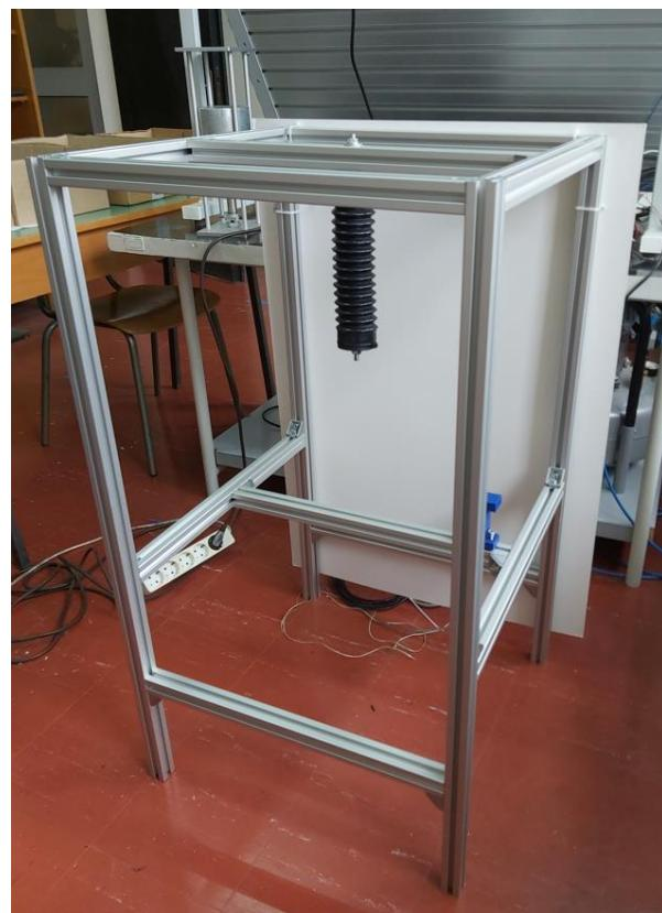
*Slika 5.6 Konstrukcija za ispitivanje pneumatskog mišića*
