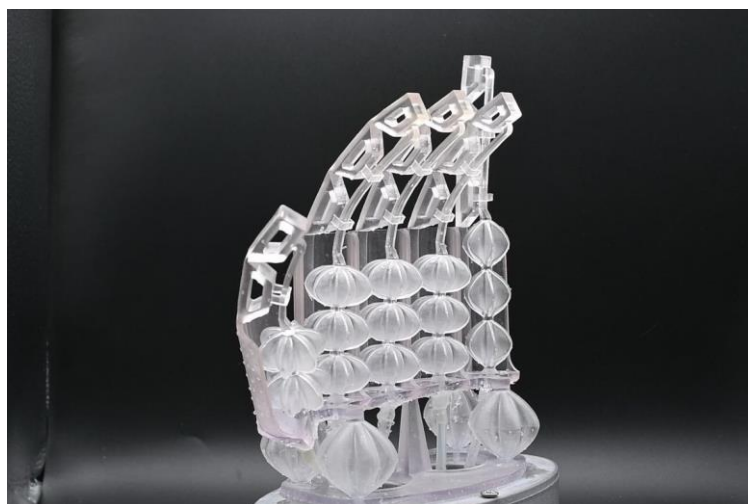
Slika 2.5 Sustav GRACE aktuatora u obliku ljudske šake [8]
