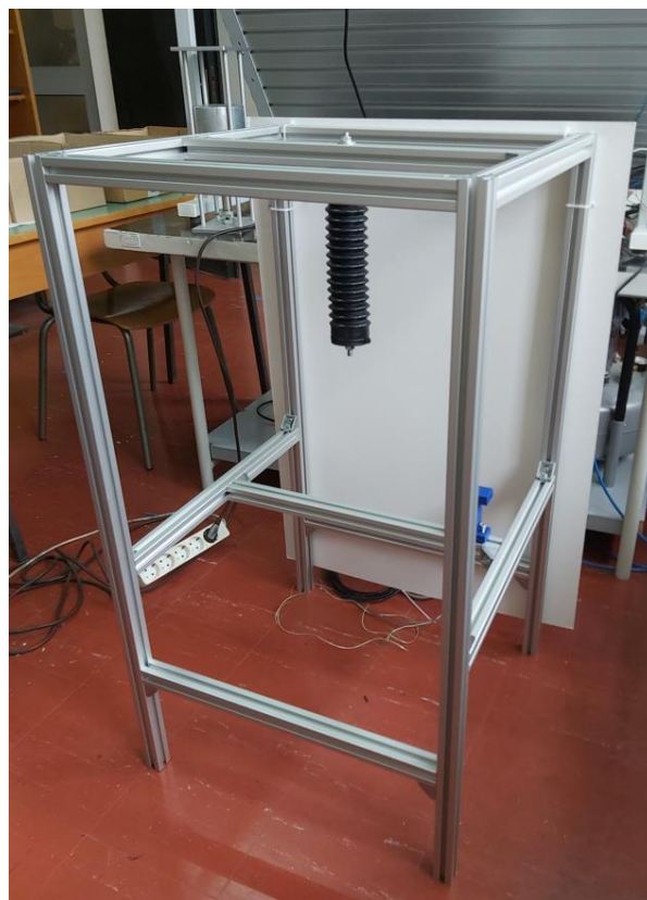
Slika 5.6 Konstrukcija za ispitivanje pneumatskog mišića
