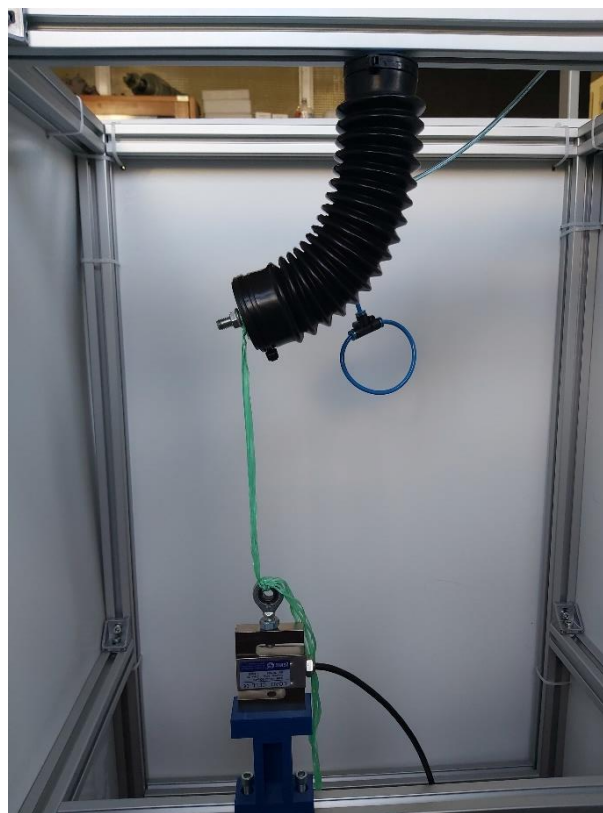
Slika 6.8 Mjerenje sile za kutni pomak od 90°
