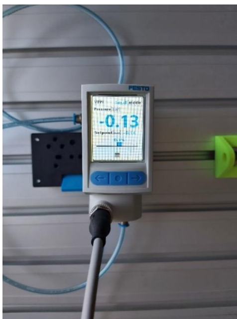
Slika 5.2 Proporcionalni regulator tlaka VPPI-5L-3-G18-1V1H-V1-S1D
