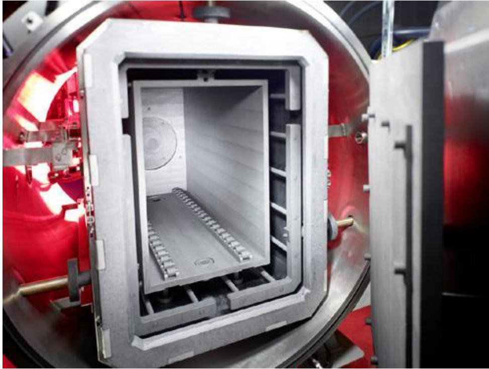
Slika 3.10. - Peć za pougljičavanje plazmom [20]
