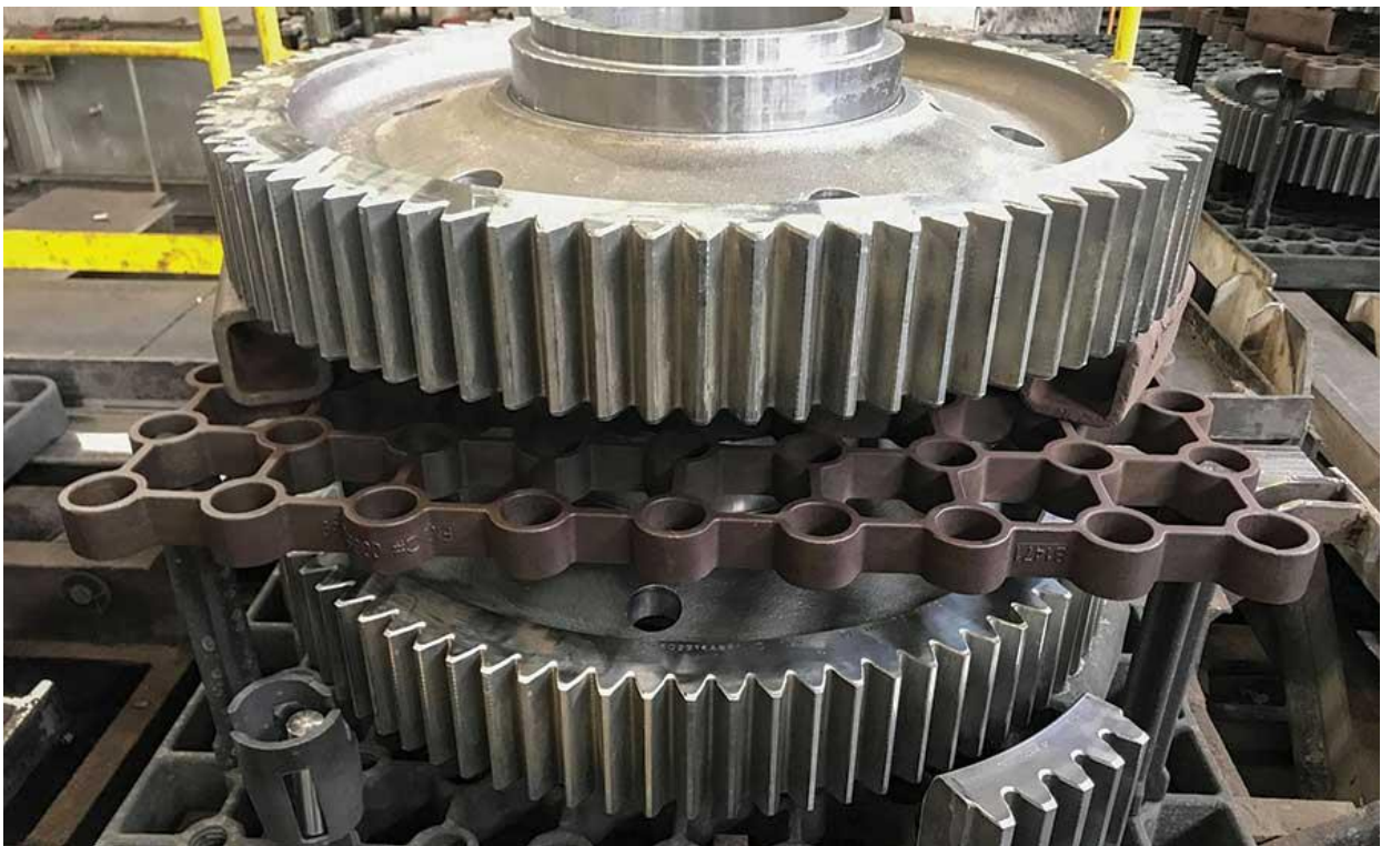
Slika 3.1. - Zupčanici stroja izrađeni od cementiranog čelika [12]
