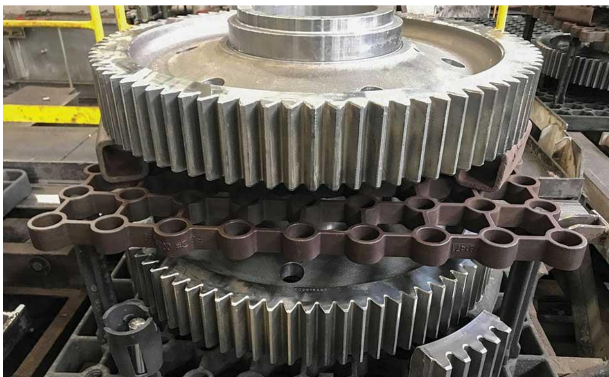
Slika 3.1. - Zupčanici stroja izrađeni od cementiranog čelika [12]
