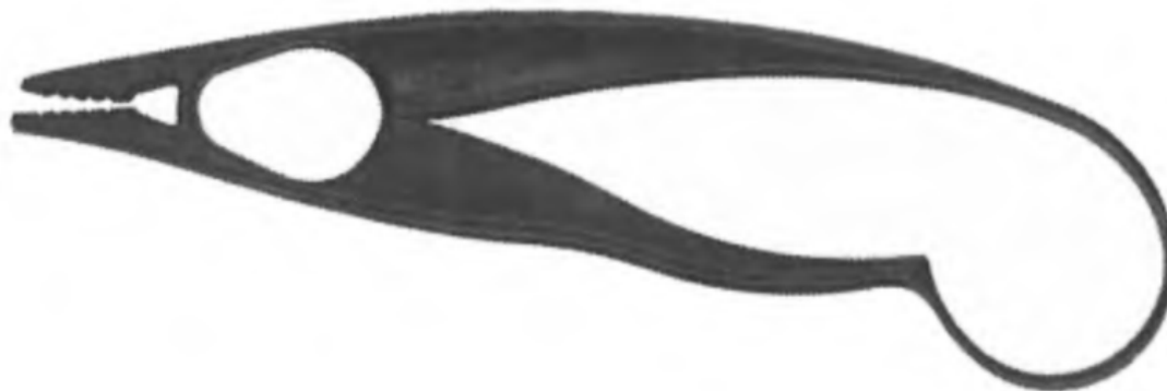
Slika 2.1 Primjer podatljivih plastičnih klješta za odstranjivanje udica izrađenih lijevanjem plastike. [1]
