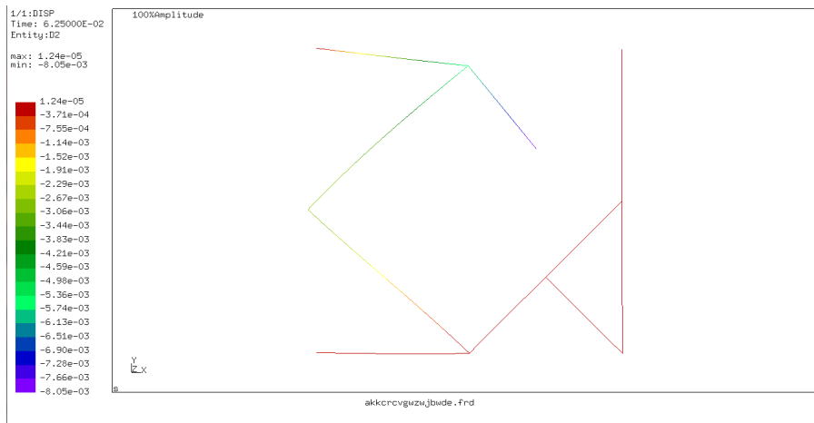
Slika 3.7 Primjer prikaza rezultata korištenjem GraphiX programa.[3] Prikazuje se iznos pomaka čvorova u smjeru Y osi jednostavnog podatljivog mehanizma.
