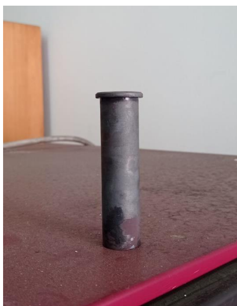
Slika 6.7 Ispitni uzorak nakon gašenja
