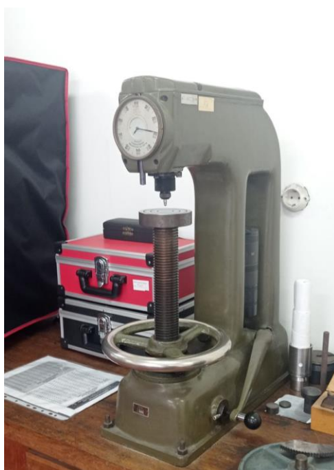
Slika 6.9 Tvrdomjer korišten za ispitivanje tvrdoće prema Rockwellovoj C metodi
