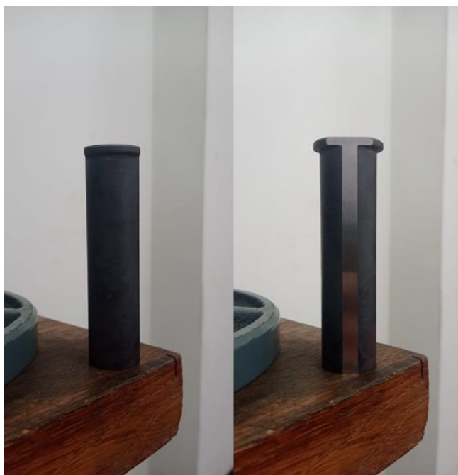
Slika 6.8 Ispitni uzorak izbrušen 0,4 mm sa dvije paralelne strane
