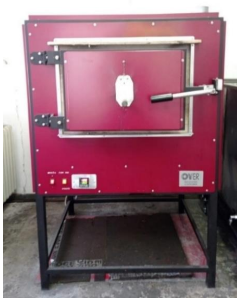
Slika 6.2 OVER komorna peć za zagrijavanje uzorka
