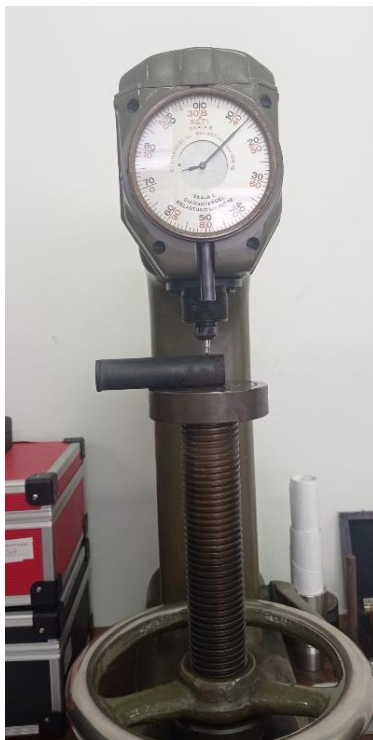
Slika 6.10 Postupak ispitivanja tvrdoće ispitne epruvete na tvrdomjeru po Rockwellovoj C metodi
