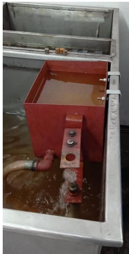
Slika 6.4 Naprava za gašenje ispitnog uzorka
