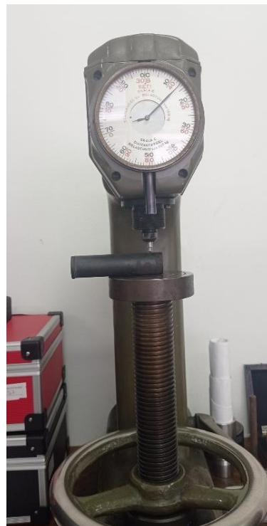
*Slika 6.10 Postupak ispitivanja tvrdoče ispitne epruvete na tvrdomjeru po Rockwellovoj C metodi*
