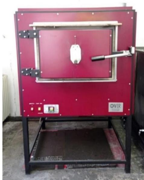
Slika 6.2 OVER komorna peć za zagrijavanje uzorka
