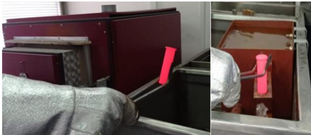
Slika 6.5 Postavljanje zagrijanog ispitnog uzorka iz peći u držač naprave za gašenje
