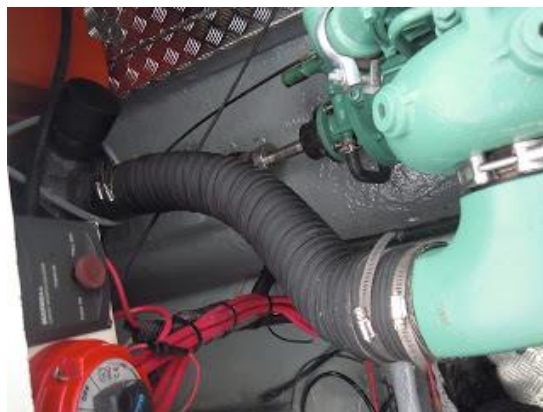
Slika 953. Gumena cijev za ispušne plinove [16]
