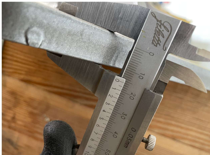
Slika 3.4 Debljina podloge vijčanog spoja konstrukcije pogonskog mehanizma
