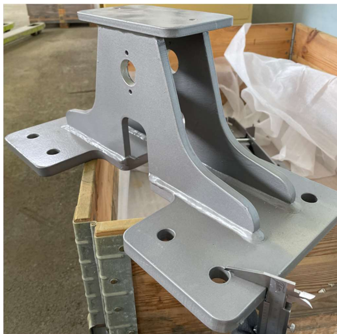
Slika 3.3 Dio pogonskog mehanizma koji povezuje nosivu konstrukciju i lance
