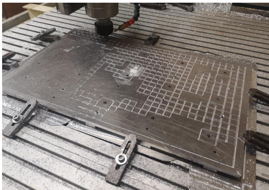
Slika 7.2. Strojna obrada gornje ploče vakuumskog stola
