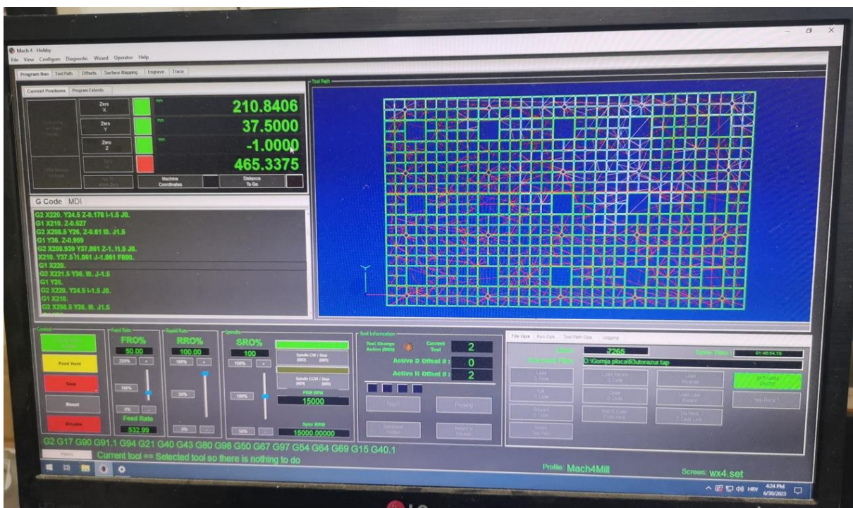
Slika 7.5. Izvršavanje G-code-a u Mach4 Mill
