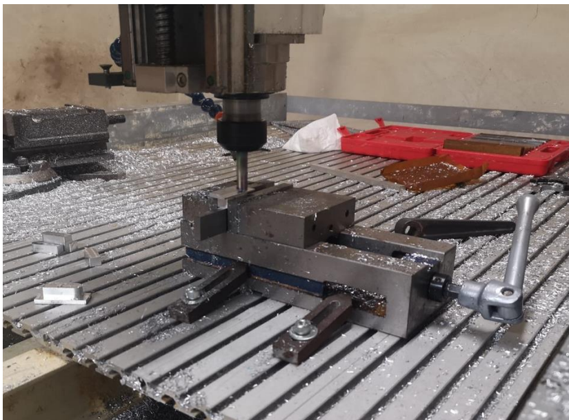
Slika 7.4. Strojna obrada graničnika
