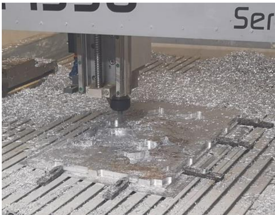
Slika 7.3. Strojna obrada donje ploče vakuumskog stola
