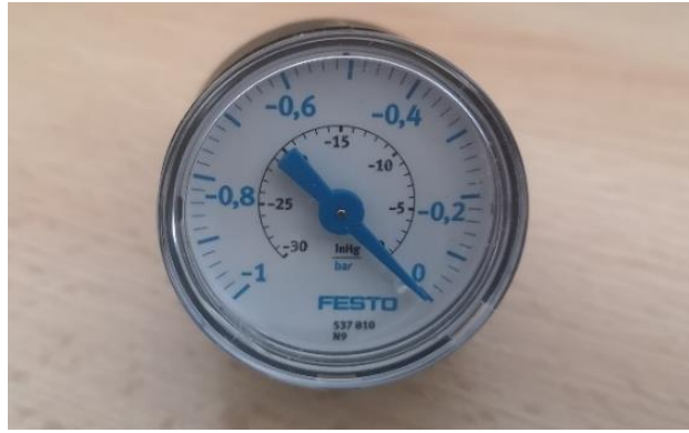
Slika 4.1.9. Prikaz analognog manometra
