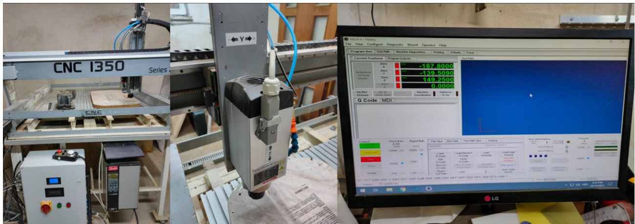
Slika 6.1. Korišteni stroj - CNC glodalica kućne izrade
