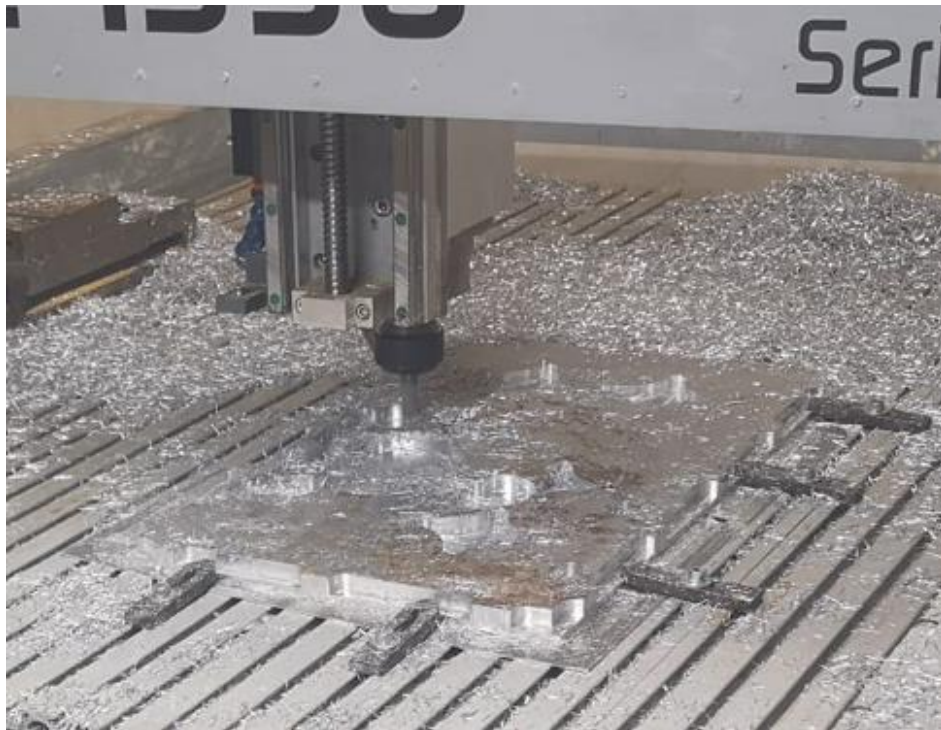
Slika 7.3. Strojna obrada donje ploče vakuumskog stola
