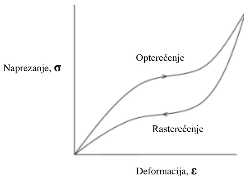
Slika 4.1. Dijagram naprezanje – deformacija viskoelastičnog materijala [61]
