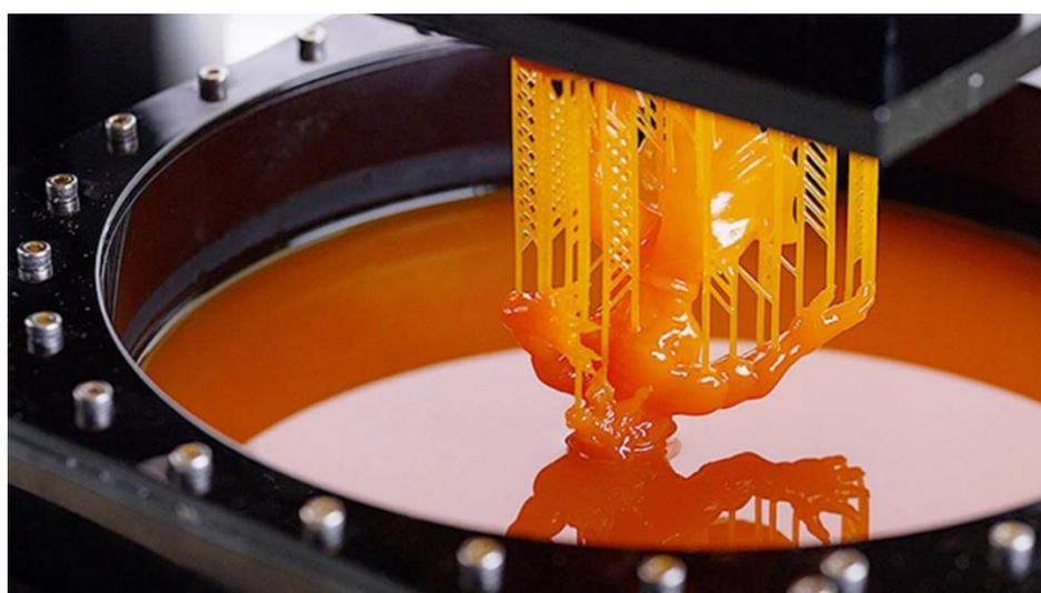
*Slika 3.9. Predmet načinjen stereolitografijom [55]*
