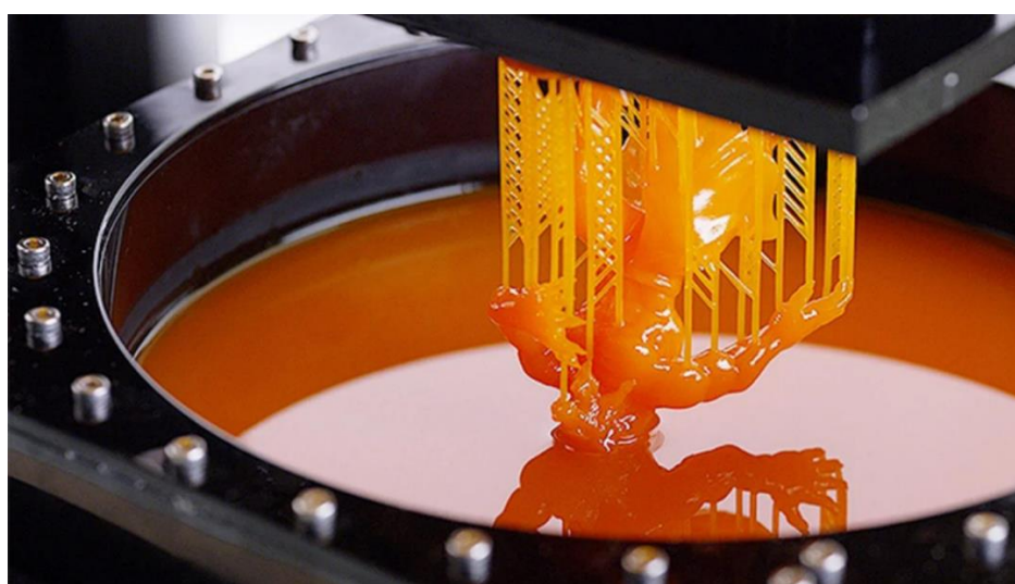
Slika 3.9. Predmet načinjen stereolitografijom [55]
