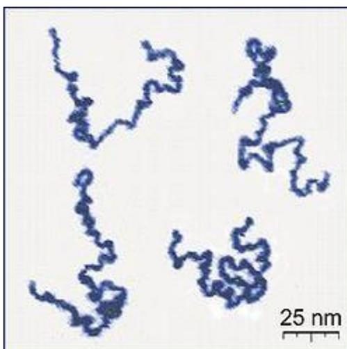
Slika 2.2. Primjer polimernih lanaca nastalih adicijskom polimerizacijom [3]
