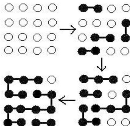
Slika 2.3. Primjer stupnjevite polimerizacije [4]
