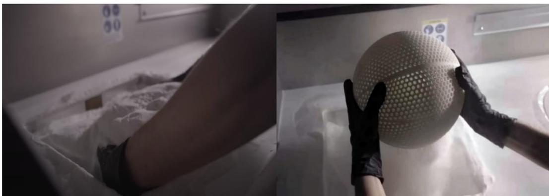
*Slika 3. 8. Wilson “Airless” prototip načinjen SLS tehnologijom [54]*
