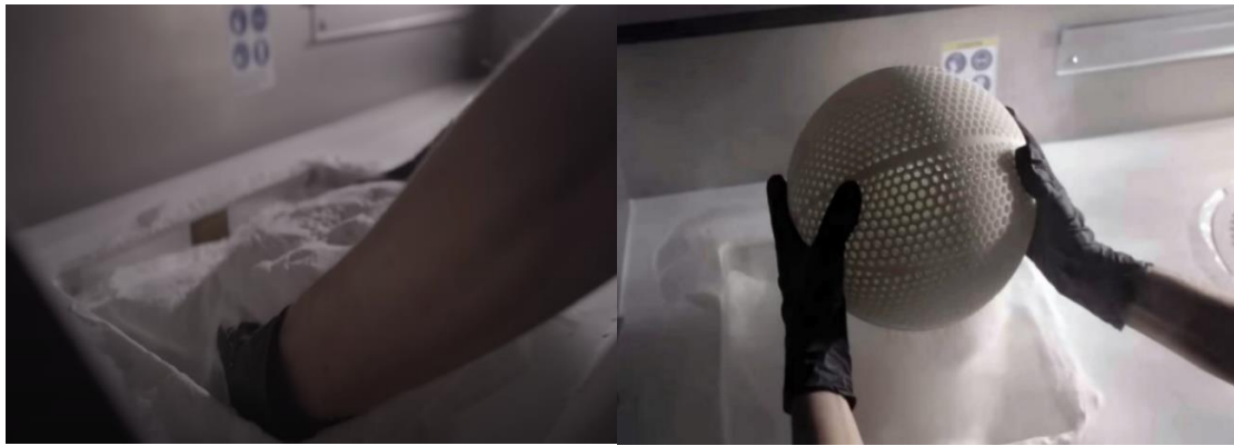
Slika 3. 8. Wilson “Airless” prototip načinjen SLS tehnologijom [54]
