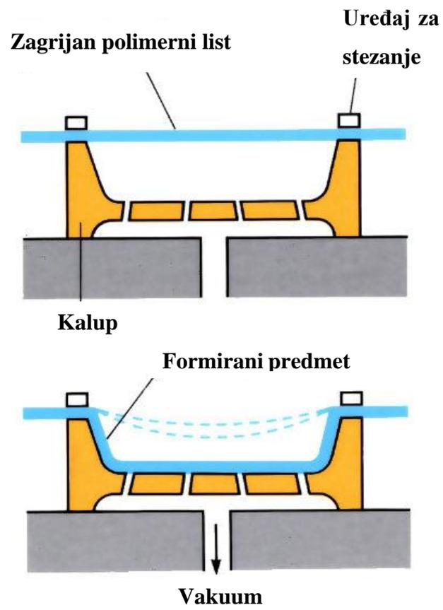
*Slika 3.11. Pojednostavljen prikaz procesa vakuumskeg oblikovanja [60]*
