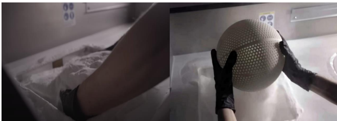
Slika 3. 8. Wilson “Airless” prototip načinjen SLS tehnologijom [54]
