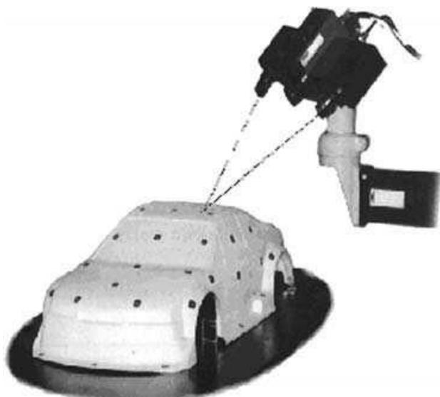
*Slika 4-4 Beskontaktni optički 3D skener [6]*
