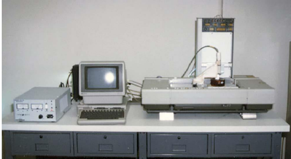
Slika 5.2-1Prvi komercijalni 3D printer kojeg je razvio Charles Hull [15]
