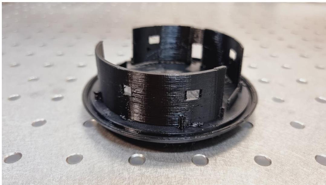
Slika 7-20 Poklopac od ventilacije automobila izgrađen 3D printerom (uspješno isprintani model)
