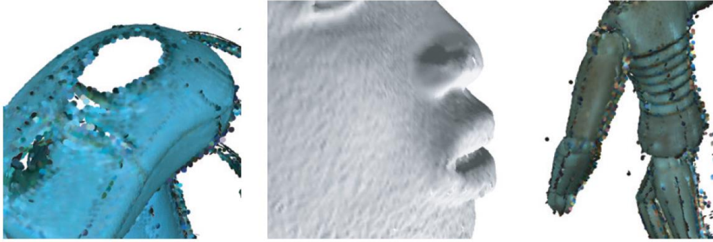
Slika 4-2 Tipični detalj rezultata skeniranja u obliku oblaka točaka, prije obrade podataka [1]
