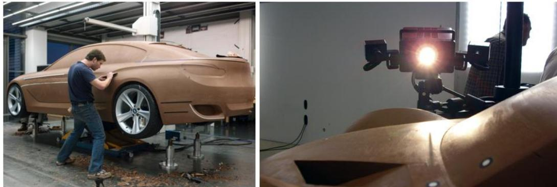
*Slika 3-1 Izrada prototipa automobila u glini [10]*
