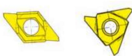
Slika 2.4 Rezne pločice za poligonalno tokarenje [4]
