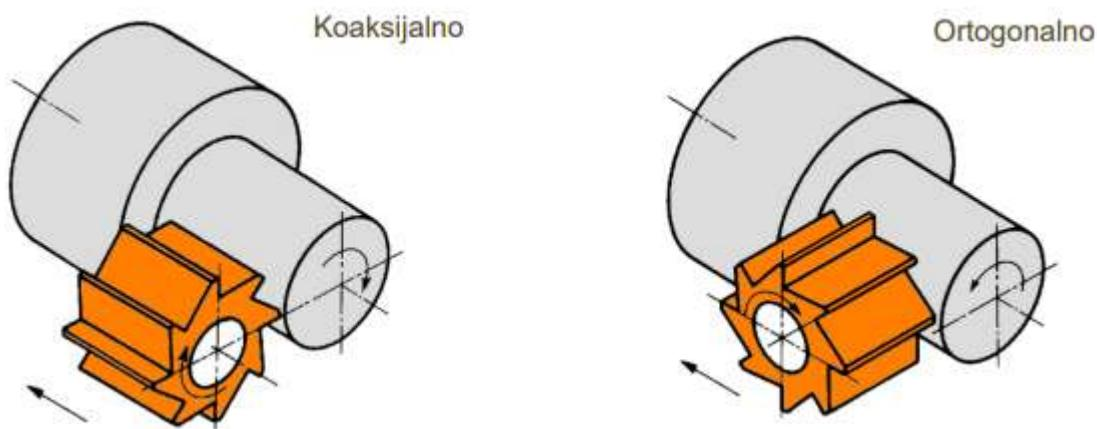
Slika 3.2 Koaksijalno i ortogonalno tokarsko glodanje [7]
