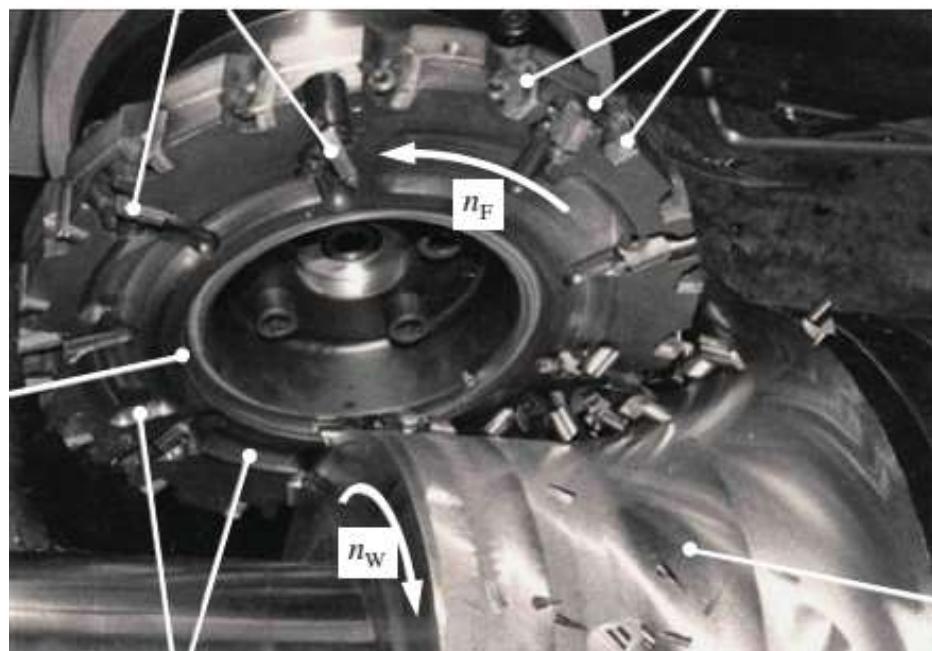
Slika 3.7 Specijalna izvedba alata za tokarsko glodanje [8]
