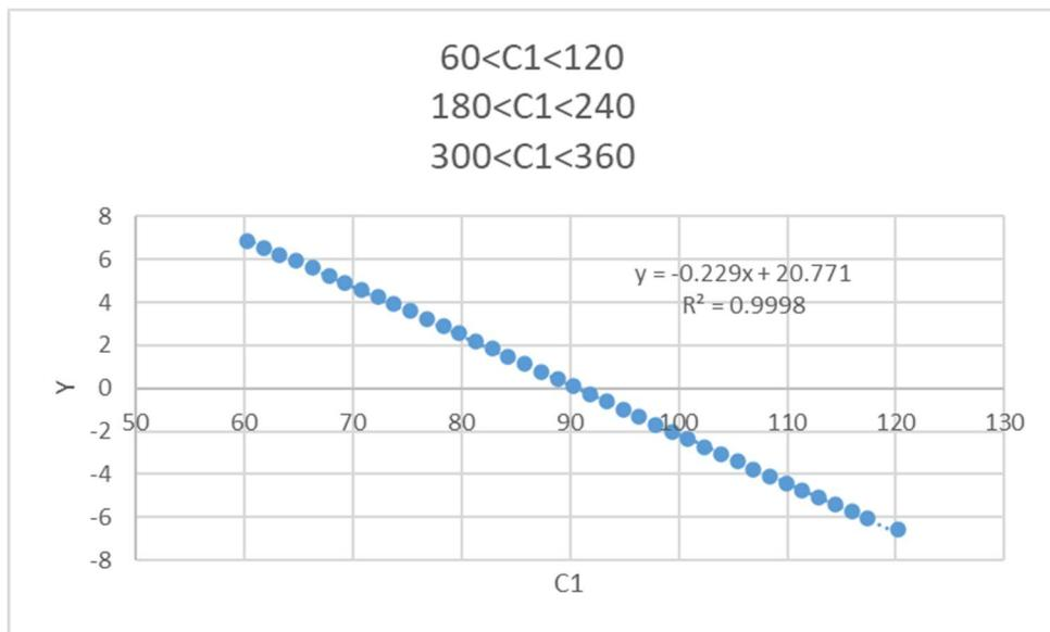
Slika 5.7 Ovisnost Y osi o osi C ( $60 < C < 120$ )
