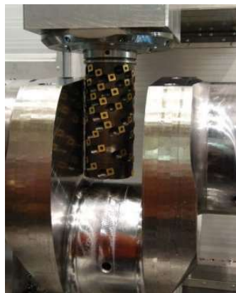
Slika 3.10 Ortogonalno tokarsko glodanje koljenaste osovine [7]
