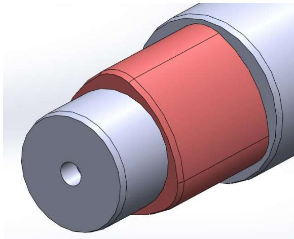
Slika 5.2 Poligonalni završetak vratila (označen crveno)
