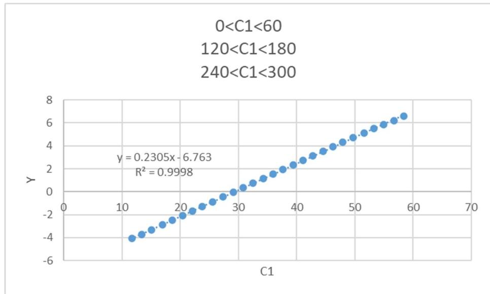
Slika 5.6 Ovisnost Y osi o osi C ( $0 < C < 60$ )
