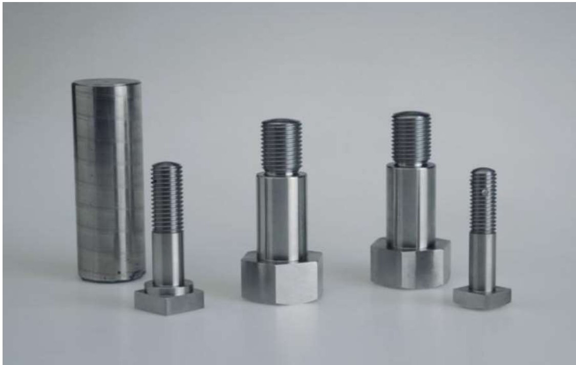
Slika 2.1 Šesterokutne glave vijaka izrađene postupkom poligonalnog tokarenja
