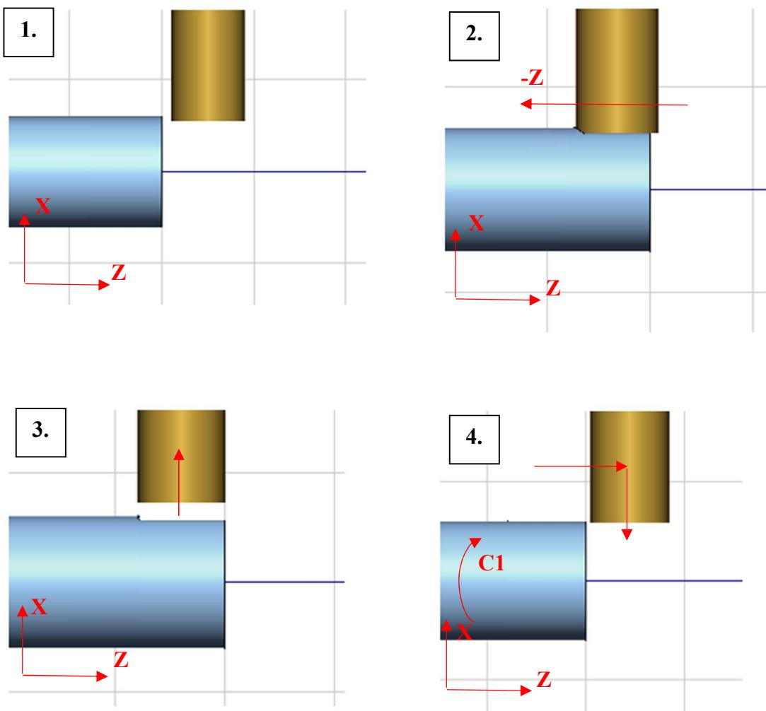
Slika 5.10 Putanja alata tijekom grube obrade poligona
