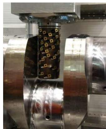
Slika 3.10 Ortogonalno tokarsko glodanje koljenaste osovine [7]
