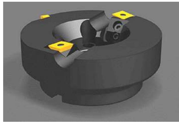
Slika 3.6 Specijalno glodalo za završnu obradu ortogonalnim tokarskim glodanjem [7]
