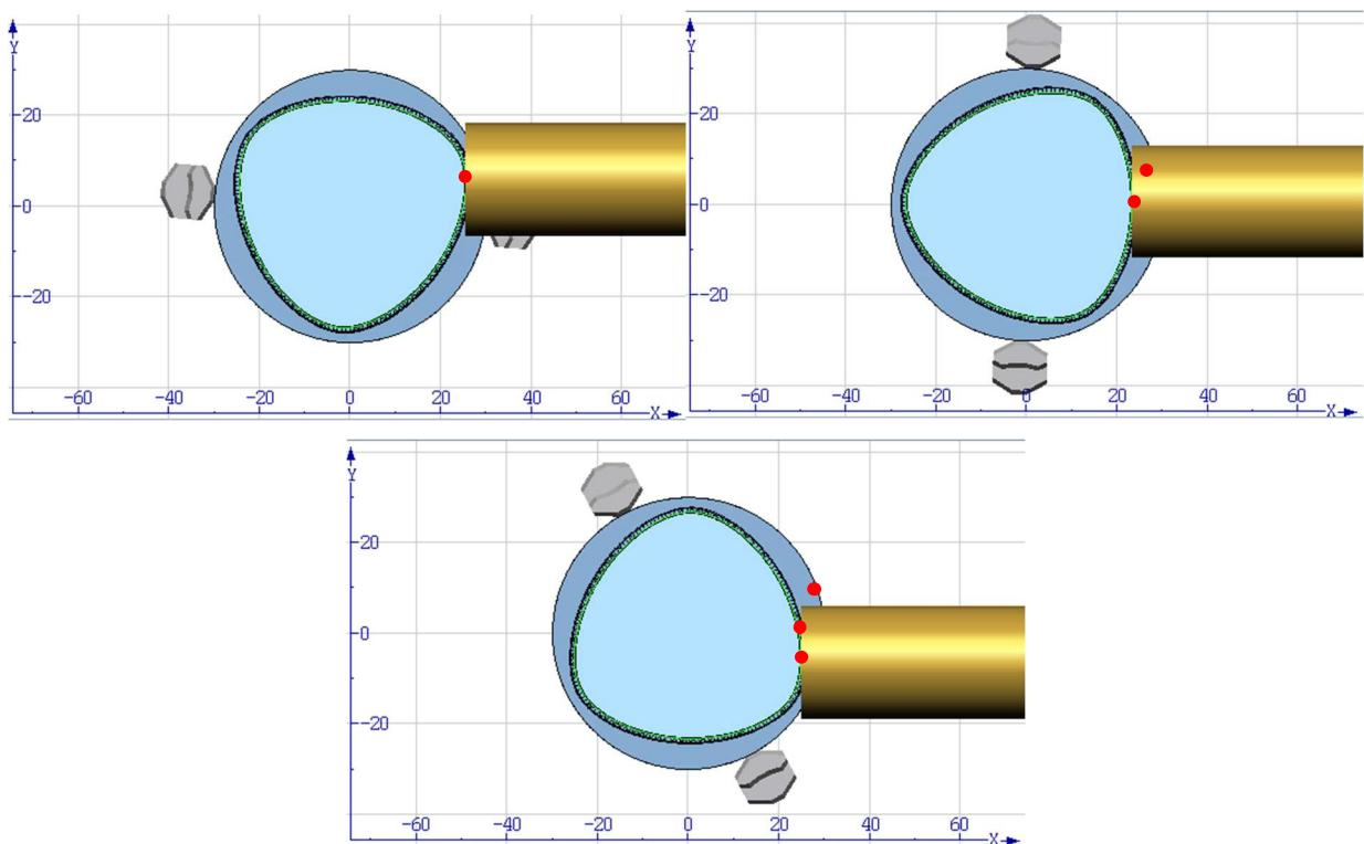
Slika 5.17 Položaj alata prilikom fine obrade poligona
