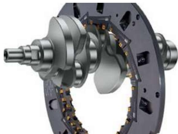
Slika 3.9 Glodalo za obilazno koaksijalno tokarsko glodanje koljenastih osovina [8]
