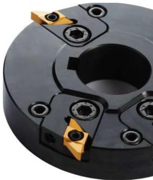
Slika 2.3 Držač alata sa podešivim utorima za rezne pločice proizvođača Dieterle [6]
