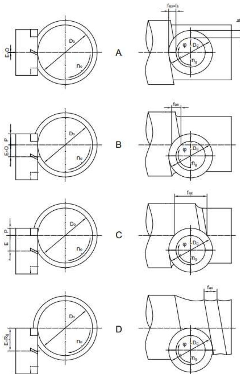
Slika 3.3 Međusobni položaji osi kod ortogonalnog tokarskog glodanja [7]
