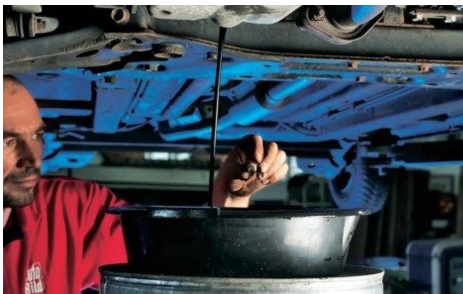
Slika 3.2. Ispuštanje starog ulja iz motora kao dio malog servisa [17]
