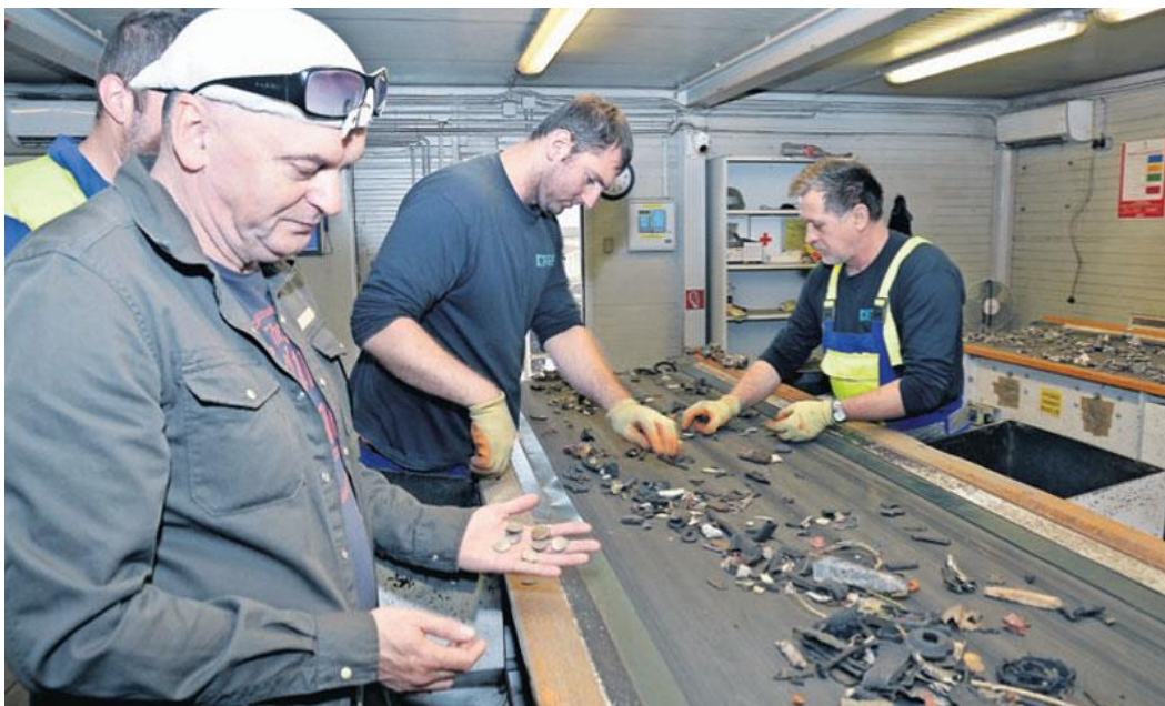
Slika 3.3. Posljednja faza odvajanja dijelova automobila za reciklažu [19]
