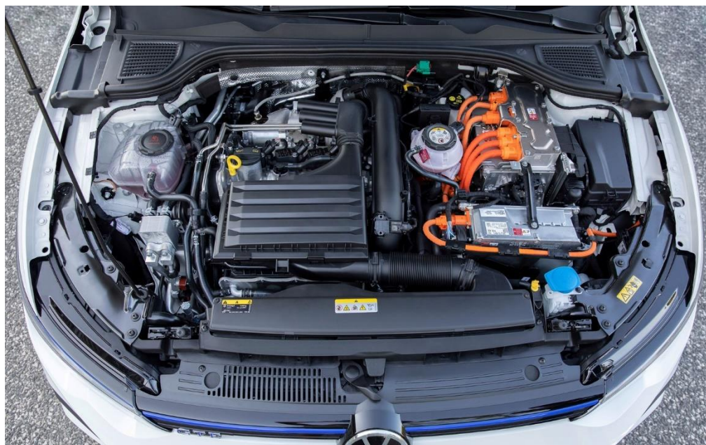
Slika 5.5. Motorni prostor Golfa VII GTE [35]
