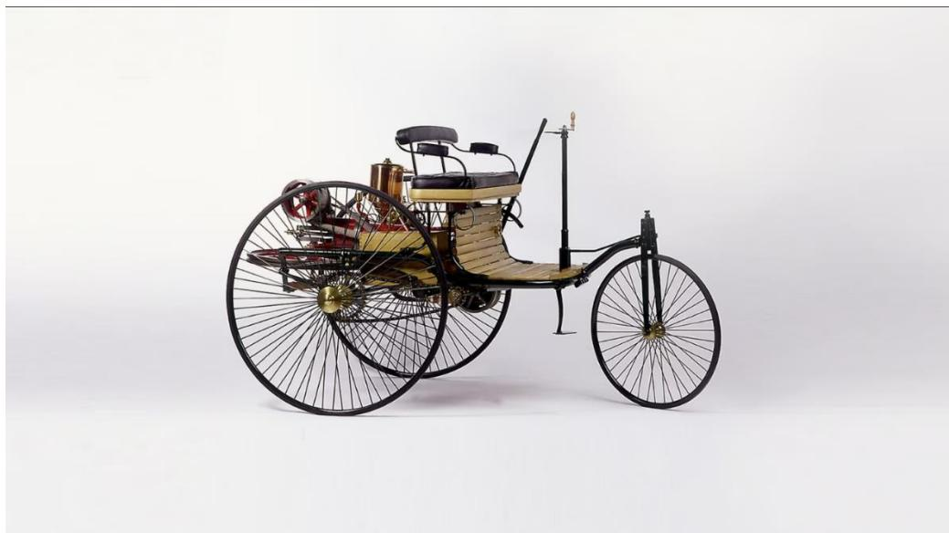
*Slika 2.2. Benz Patent-Motorwagen – prvi automobil [3]*
