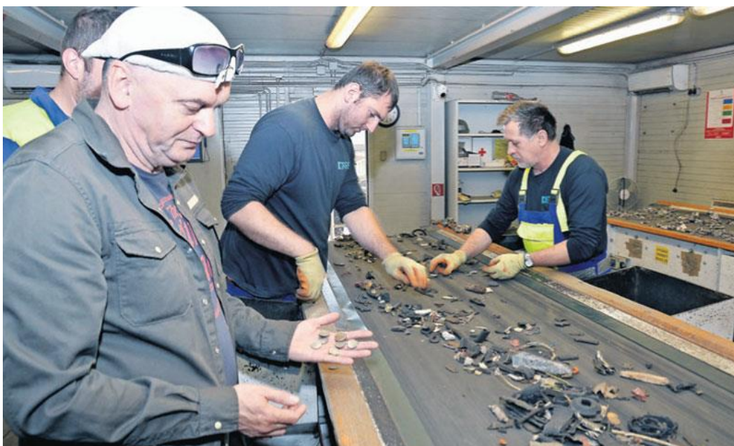
Slika 3.3. Posljednja faza odvajanja dijelova automobila za reciklažu [19]
