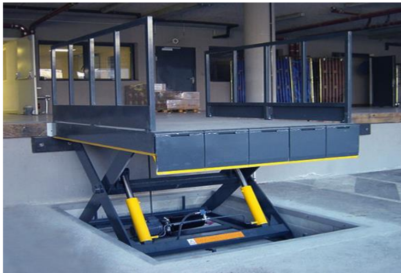
Slika 2.4. Postolje ugrađeno u posebnoj rupi [8]
