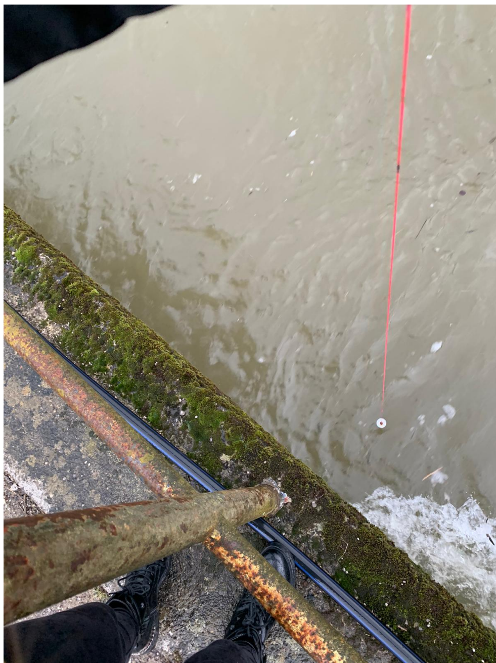
Slika 4.5 Mjerenje dubine rijeke
