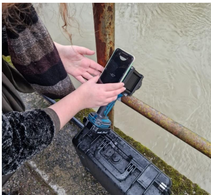
Slika 4.7 Provjera nagiba radarskog uređaja pomoću mobilne aplikacije
