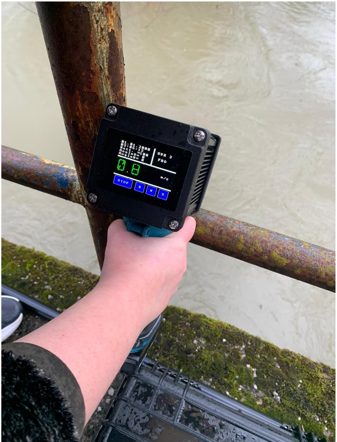
*Slika 4.8 Mjerenje površinske brzine strujanja vode na jednoj od pozicija*
