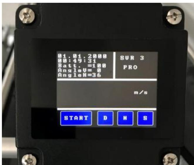
Slika 2.3 LCD zaslon radarskog uređaja Viatronics model VT-SVR-PRO 3
