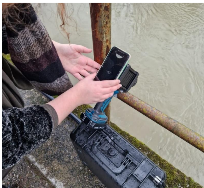
Slika 4.7 Provjera nagiba radarskog uređaja pomoću mobilne aplikacije
