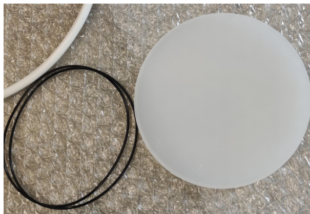
Slika 3.38. O-ring i akrilno staklo nakon tokarenja
