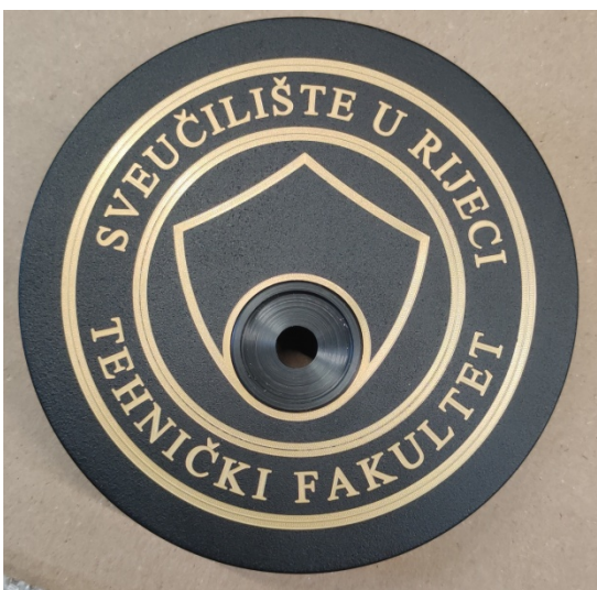
Slika 4.42. Izgled gravura nakon kromatiranja
