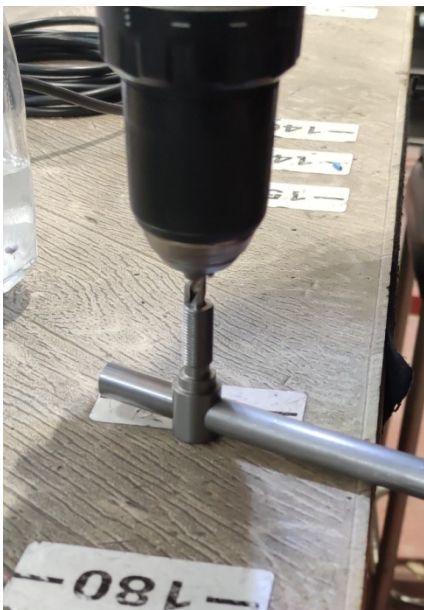
Slika 4.33. Bušenje spojnog vijka (lijevo); spojni vijak (desno)
