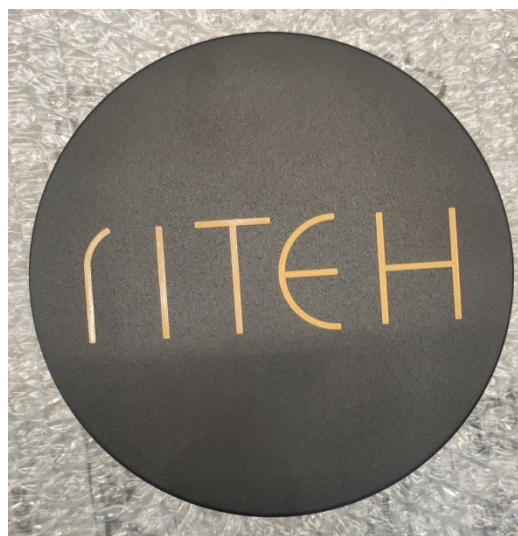
Slika 4.42. Izgled gravura nakon kromatiranja
