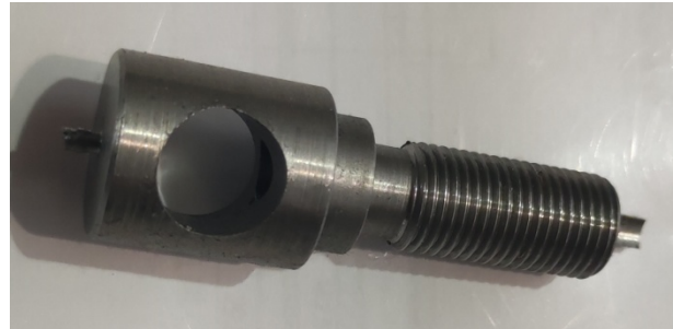
Slika 4.31. Okretni vijak - gotovi komad
