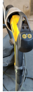
Slika 4.29. Uređaj i pištolj za ručno nanošenje praha
