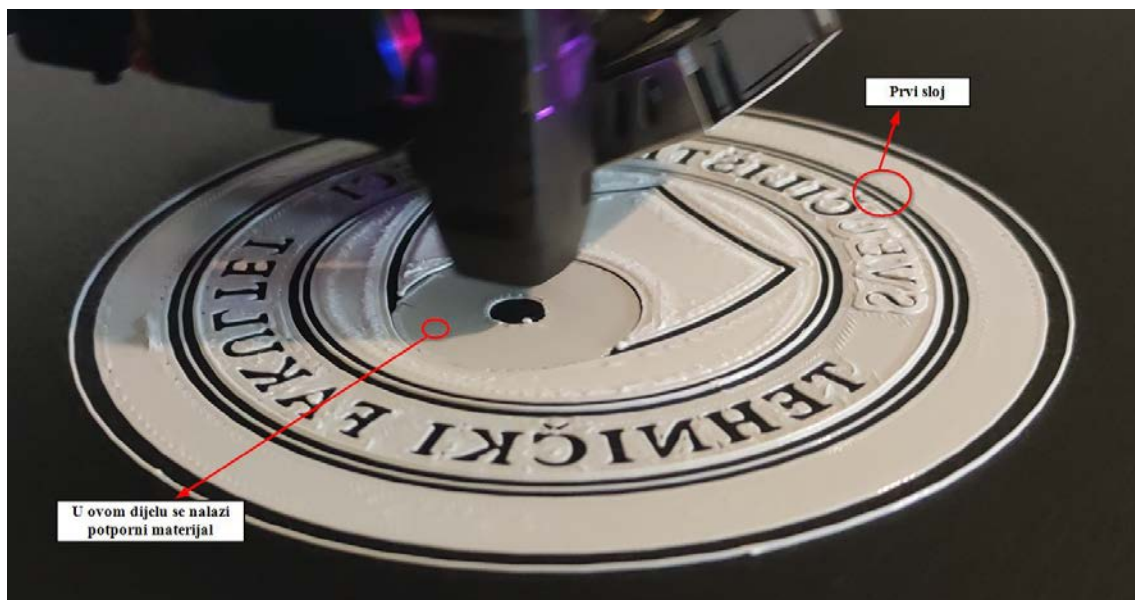
Slika 3.32. Prvi sloj printanja
