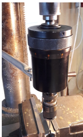
Slika 4.36. Glava za izradu navoja
