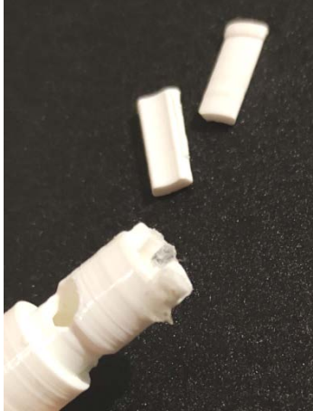
Slika 3.16. Škart - polomljeni uskočni segmenti
