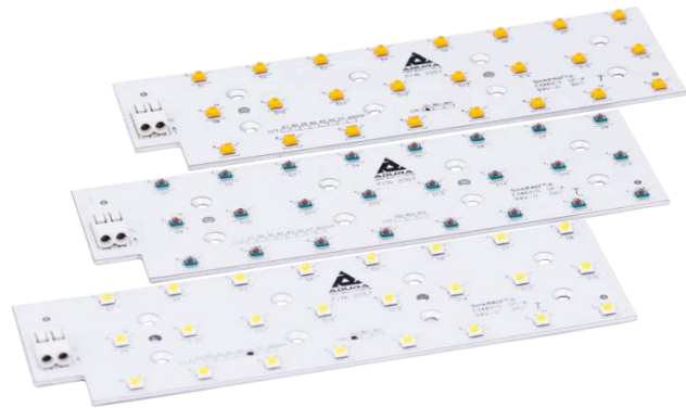
Slika 2.7. Primjer LED modula [15]
