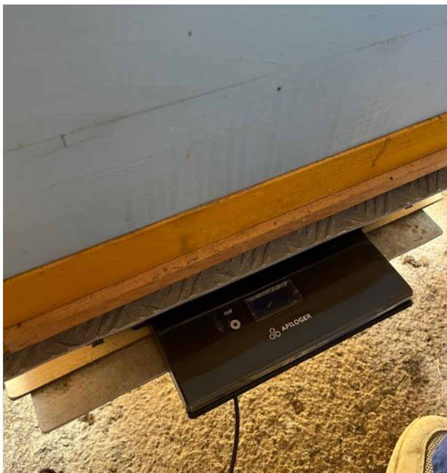
Slika 4.8 Pčelarska vaga ispod košnice ~ vlastiti izvor
