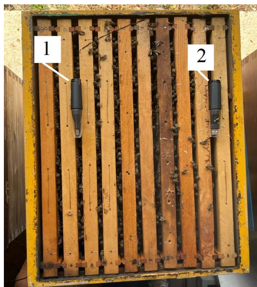
Slika 4.10 Loggeri u košnici ~ vlastiti izvor
