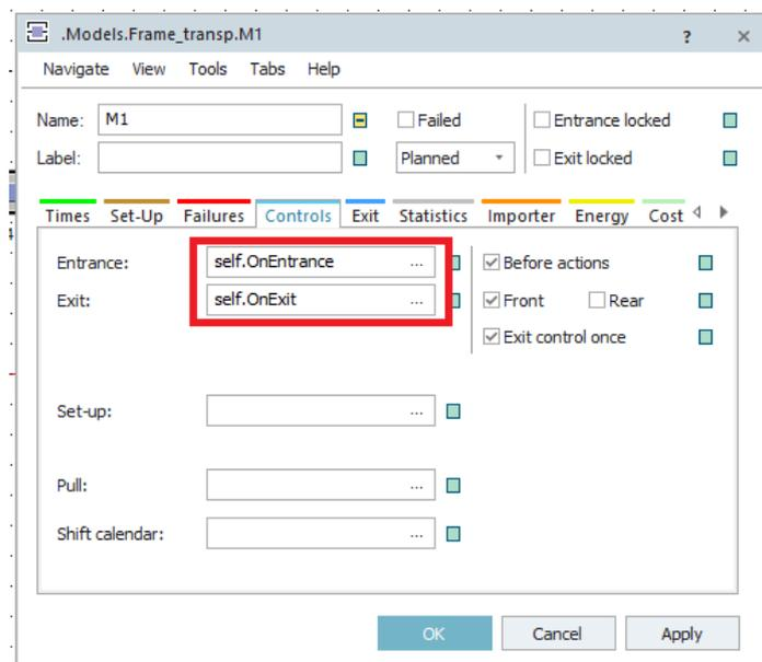
Slika 6.12 Programiranje ulazne i izlazne kontrole stroja
