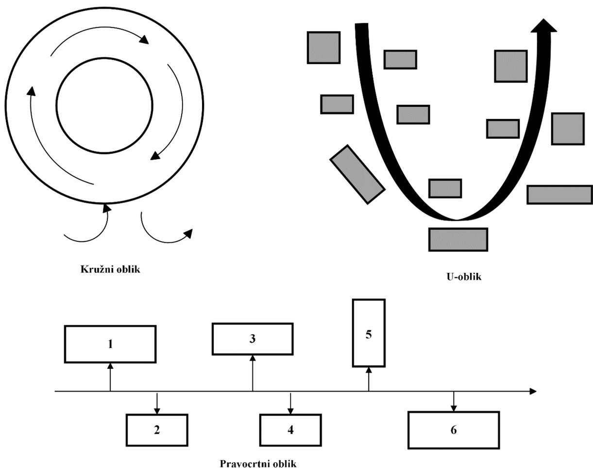
Slika 2.5 Primjeri tokova obrade u linijskoj proizvodnji [1]
