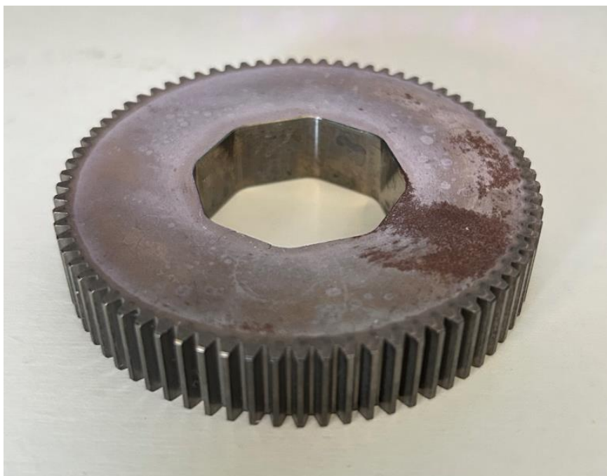
Slika 4.1 Zupčanik - m1; z75 (proizvod A)
