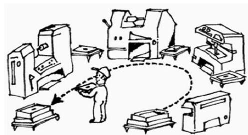
*Slika 2.6 Proizvodnja veće količine proizvoda po principu radioničke proizvodnje i u proizvodnoj ćeliji [10]*
