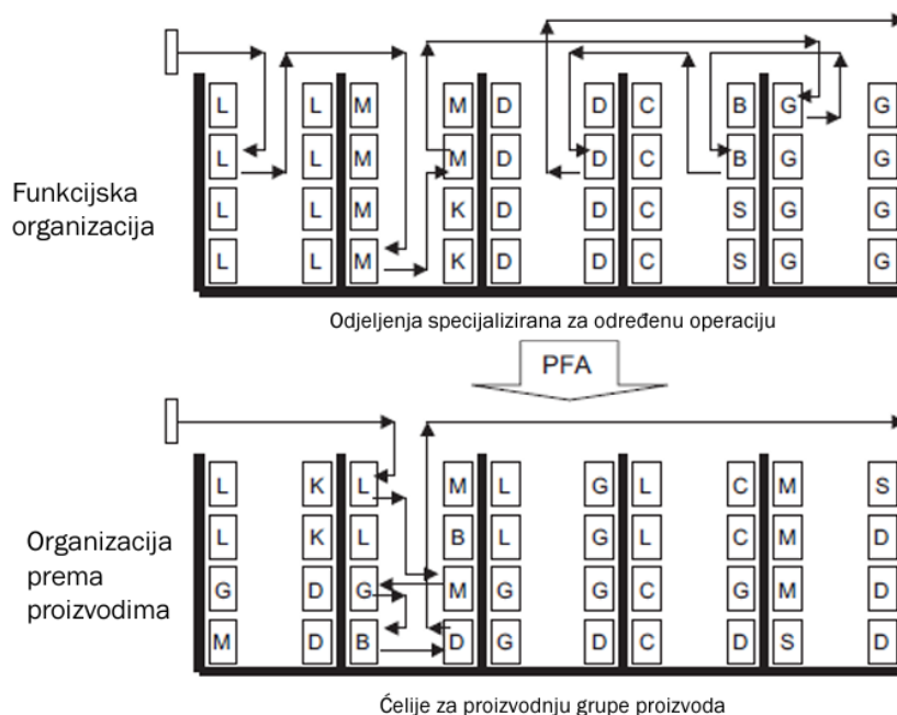
Slika 3.2 Transformacija proizvodnog sustava s pomoću metode analize toka materijala (PFA) [11]
