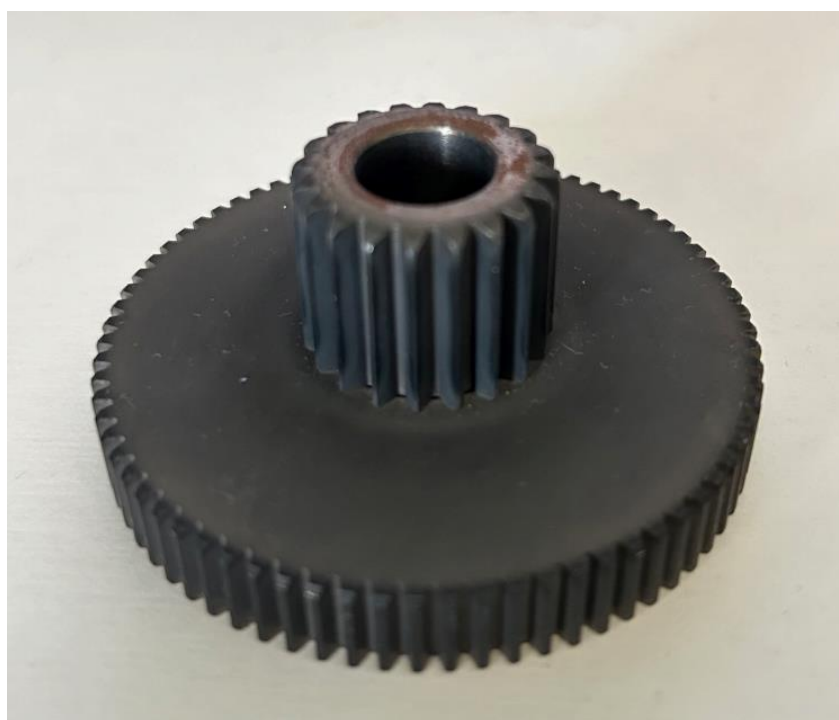
Slika 4.2 Zupčanik – m1; z20/m0,9; z75 (proizvod D)
