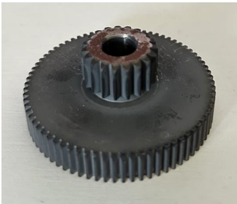
Slika 4.3 Zupčanik m0,8;z19/m0,6;z74 (proizvod E)
