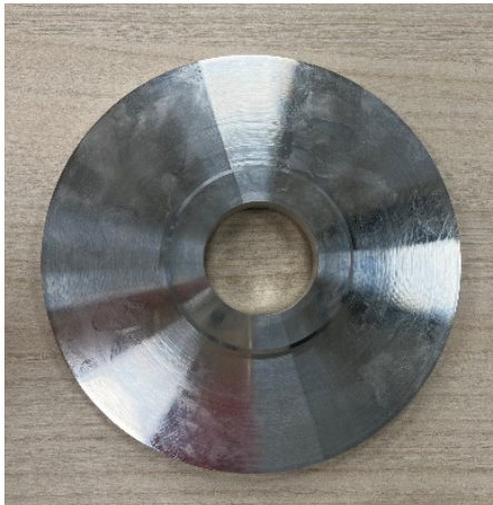
Slika 5.42. Transportno kolo nakon operacije 40-1
