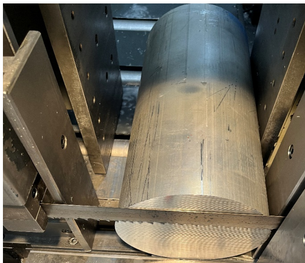
Slika 5.3. Postavljanje nule u procesu piljenja
