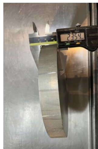
Slika 5.6. Kontrola dimenzije dužine prepiljene šipke
