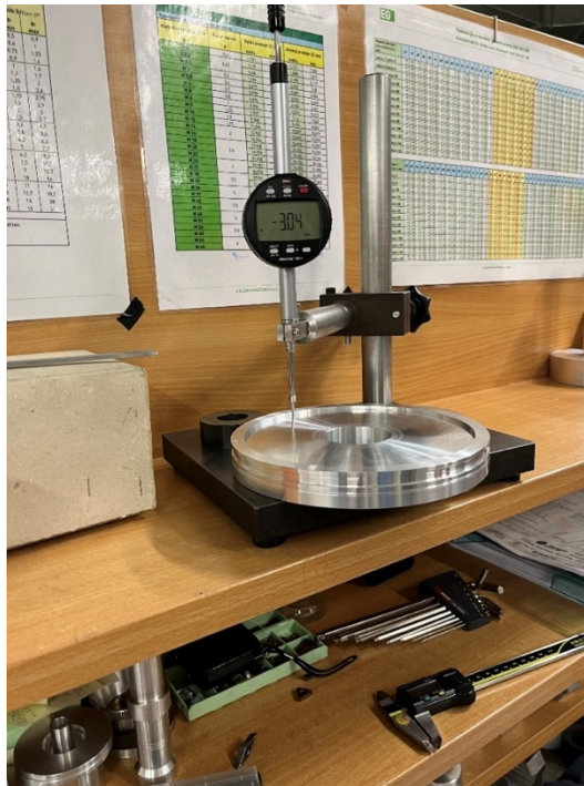
Slika 5.34. Kontrola dimenzije transportnog kola nakon operacije 30
