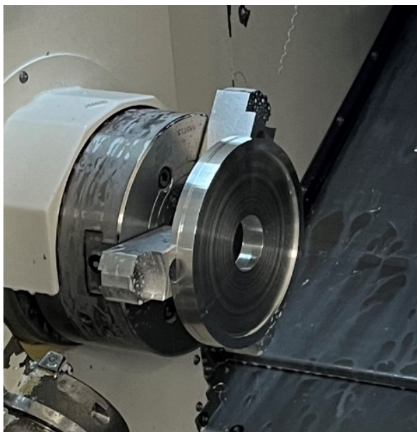
Slika 5.35. Stezanje ulaznog materijala za operaciju 40
