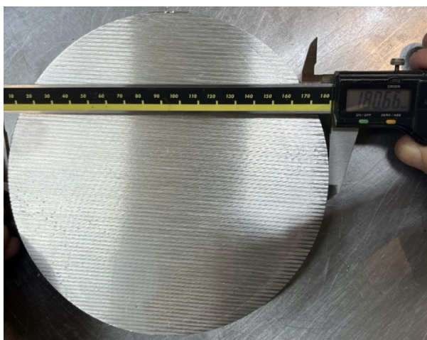
Slika 5.5. Kontrola dimenzije promjera šipke
