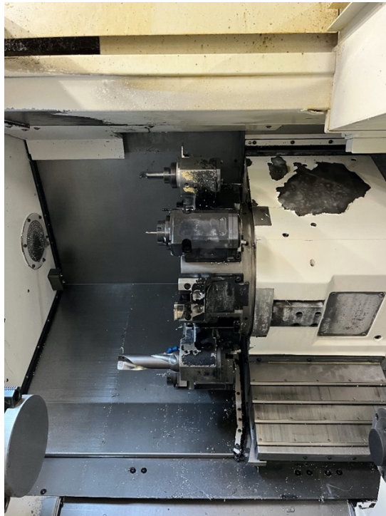
Slika 4.4. Revolverska glava (12 pozicija alata)
