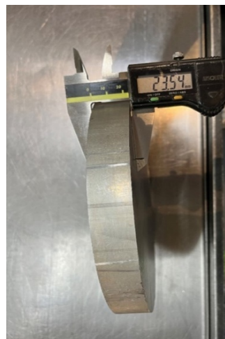
Slika 5.6. Kontrola dimenzije dužine prepiljene šipke
