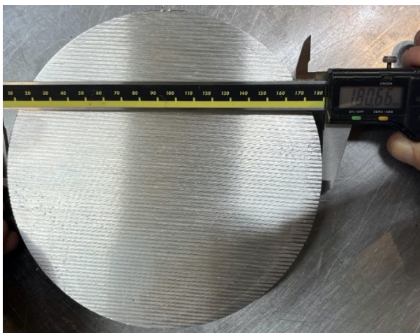
Slika 5.5. Kontrola dimenzije promjera šipke
