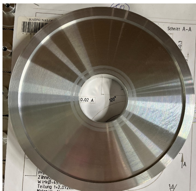
Slika 5.33. Transportno kolo nakon operacije 30
