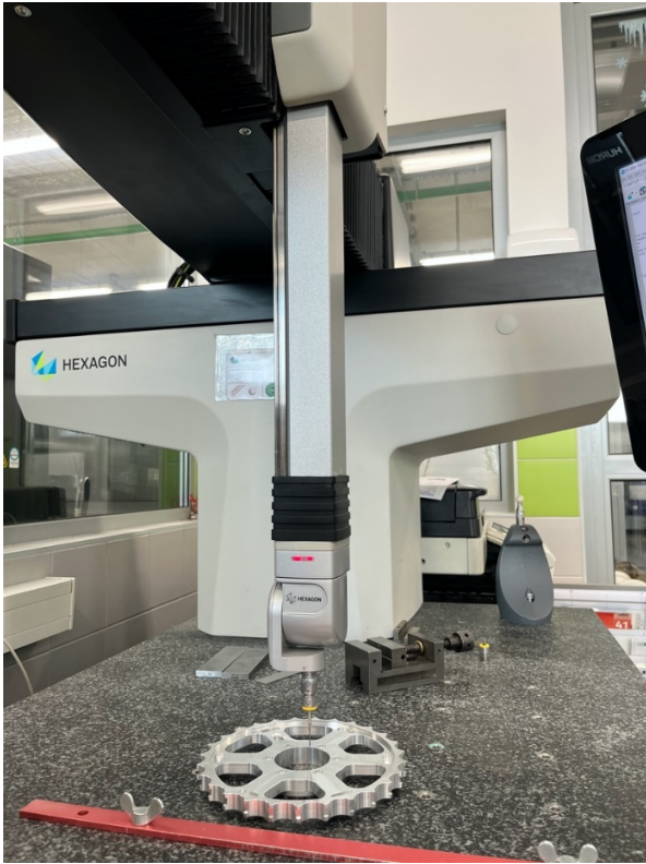
Slika 5.77. Završna kontrola transportnog kola (CMM)
