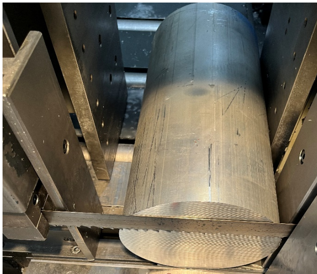
Slika 5.3. Postavljanje nule u procesu piljenja
