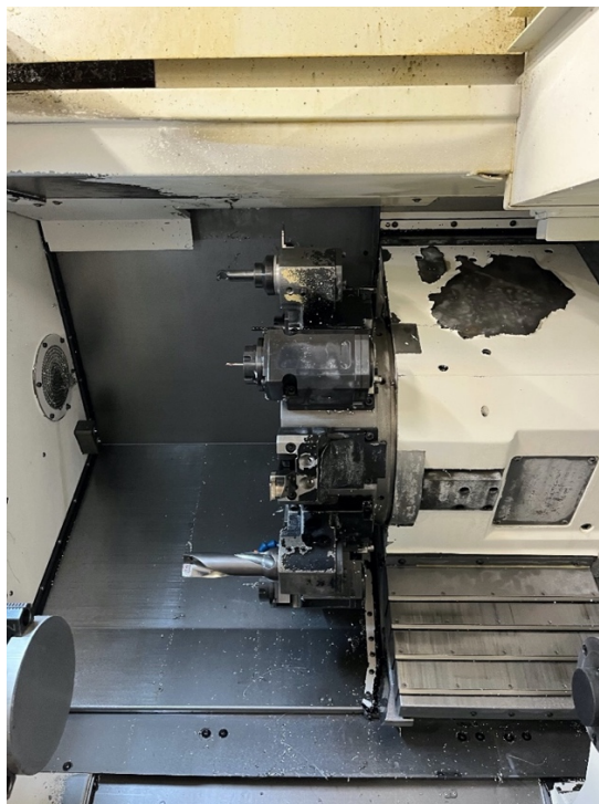
Slika 4.4. Revolverska glava (12 pozicija alata)
