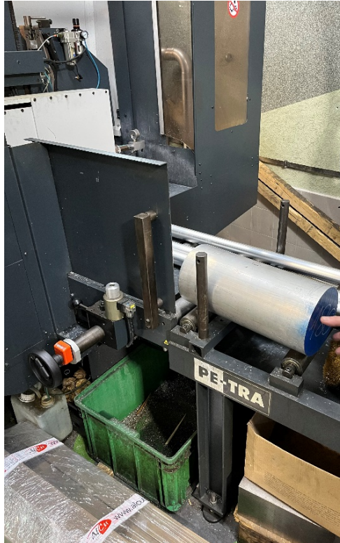
Slika 5.1. Postavljanje šipke na pilu
