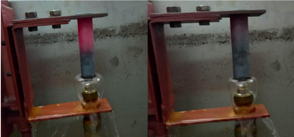
Slika 7.7. Stanje uzorka nakon 3 minute i 4 minute gašenja
