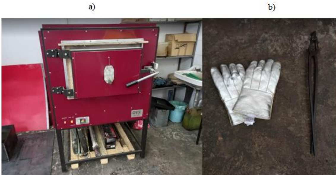
Slika 7.3. a) Peć za toplinsku obradu;; b) Oprema
