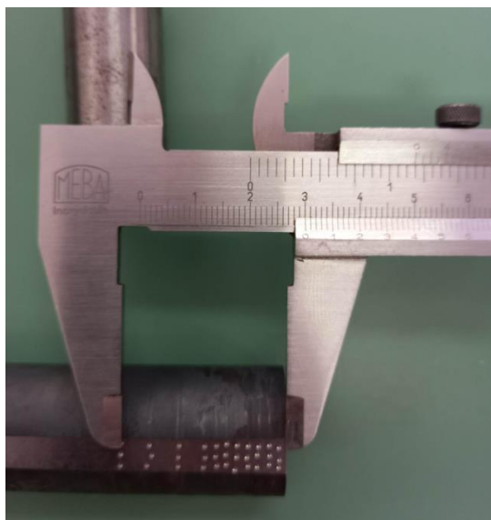
Slika 7.12. Provjera udaljenosti od gašenog čela Jominyjevog uzorka
