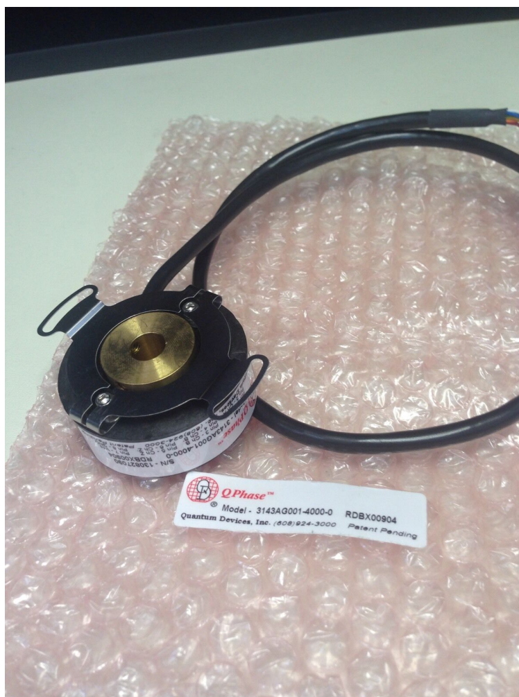
Slika 10.2. Quantum Devices QPhase Optički inkrementalni enkoder
