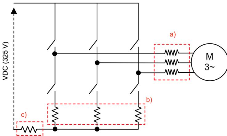
Slika 4.2. Metode mjerena struje u odnosu na broj i mjesto shunt otpornika. [9]
