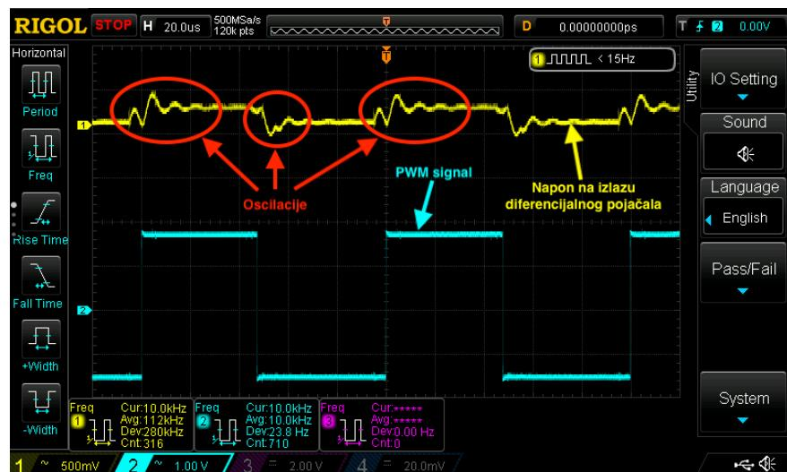
Slika 6.10. Oscilacije signala mjerene struje faze elektromotora.
