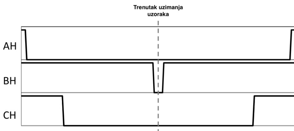
Slika 4.4. PWM signal svih triju faz s naznačenim trenutkom uzimanja uzorka struja. [9]
