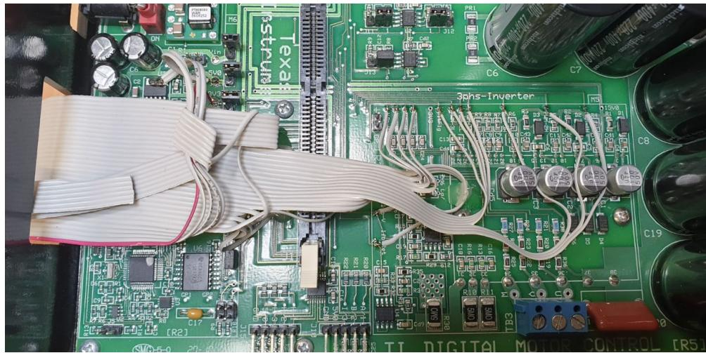
*Slika 3.3. Zaledljeni vodovi na tiskanoj pločici energetske elektronike*
