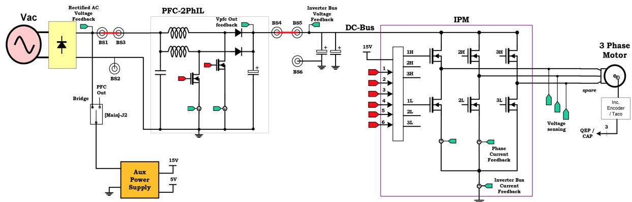
Slika 3.1. Blokovski dijagram HVMotorCtrl+PFCKit-R5 energetske elektronike [6]
