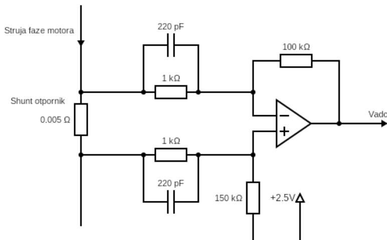
Slika 4.8. Diferencijalno pojačalo za mjerjenje struje pomoću shunt otpornika.
