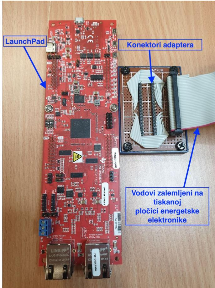
*Slika 3.4. Adapter pričvršćen na LaunchPad mikroprocesorski sustav*
