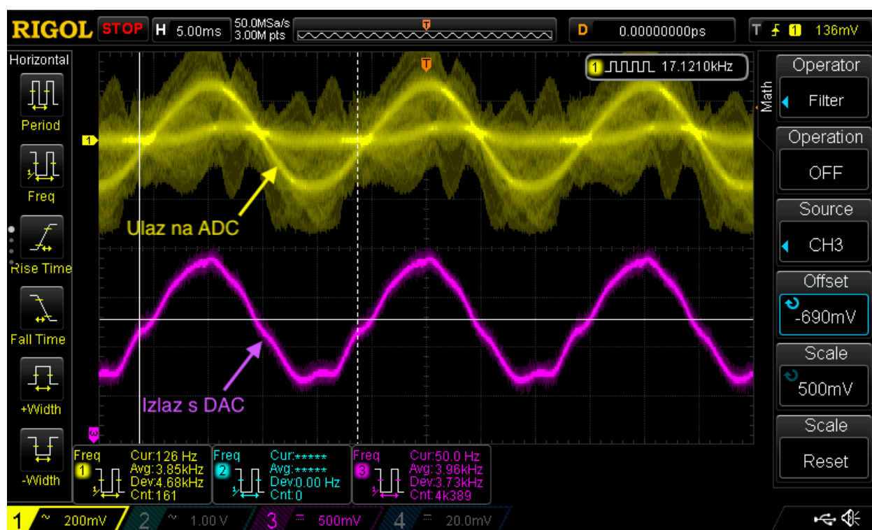
Slika 4.11. Signal na ulazu u AD pretvornik i signal na izlazu DA pretvornika.
