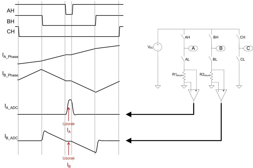
Slika 4.6. Nedovoljno vremena za mjerjenje struje faze A [9]
