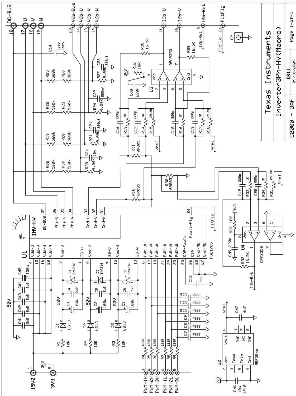
Slika 10.4. Shema HVMotorCtrl+PFCKit-R5 energetske elektronike - dio 2/2 [5]
