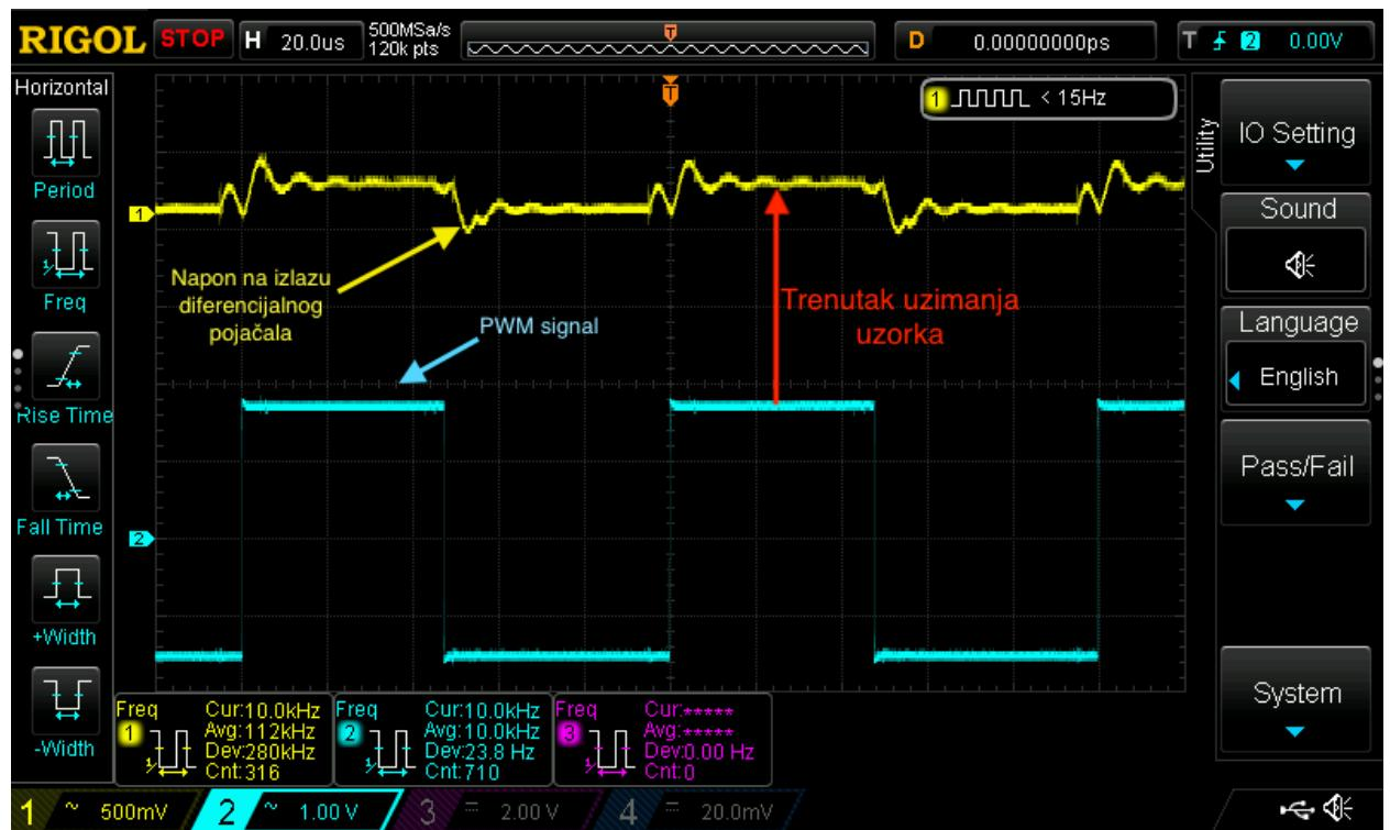
Slika 4.9. Mjerjenje PWM signala i napona na izlazu diferencijalnog pojačala pri praznemu hodu elektromotora.
