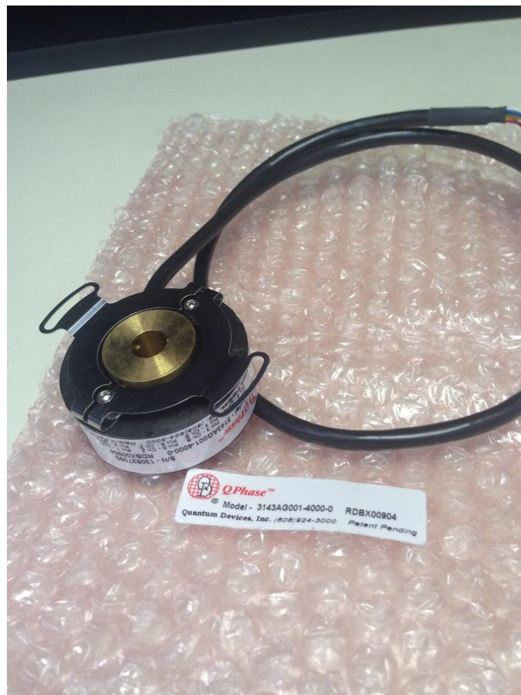
Slika 10.2. Quantum Devices QPhase Optički inkrementalni enkoder
