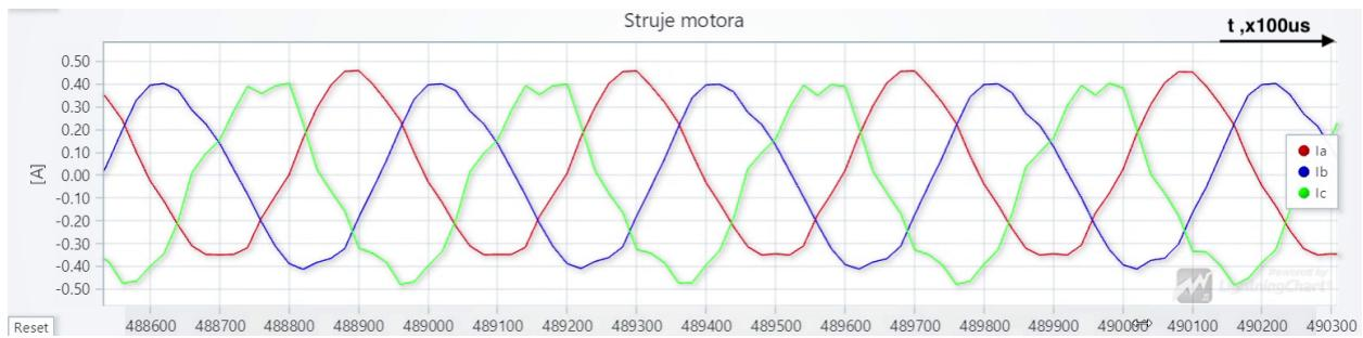
Slika 6.4. Prikaz valnih oblika mjerene struja faza motora.
