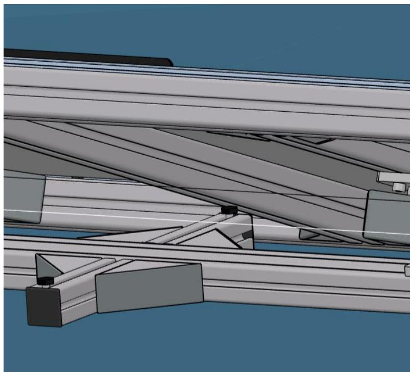
*Slika 3.24 Stoper u kontaktu s rotacijskom platformom*
