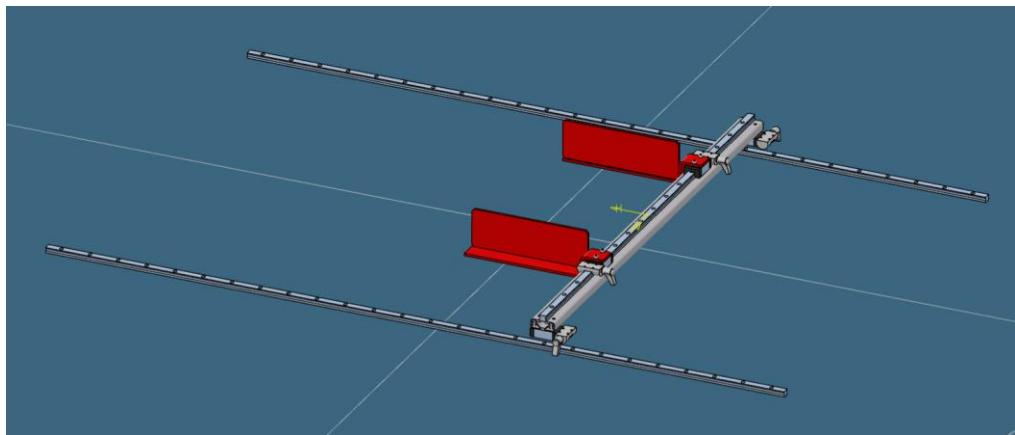
Slika 5.20 Dijelovi fiksatora koje je potrebno izraditi
