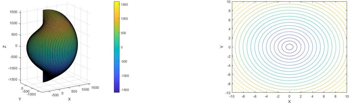
Slika 4.7. Prikaz rješenja električnog potencijala  $\varphi(\phi)$  sa pripadnim ekvipotencijalnim plohama.
