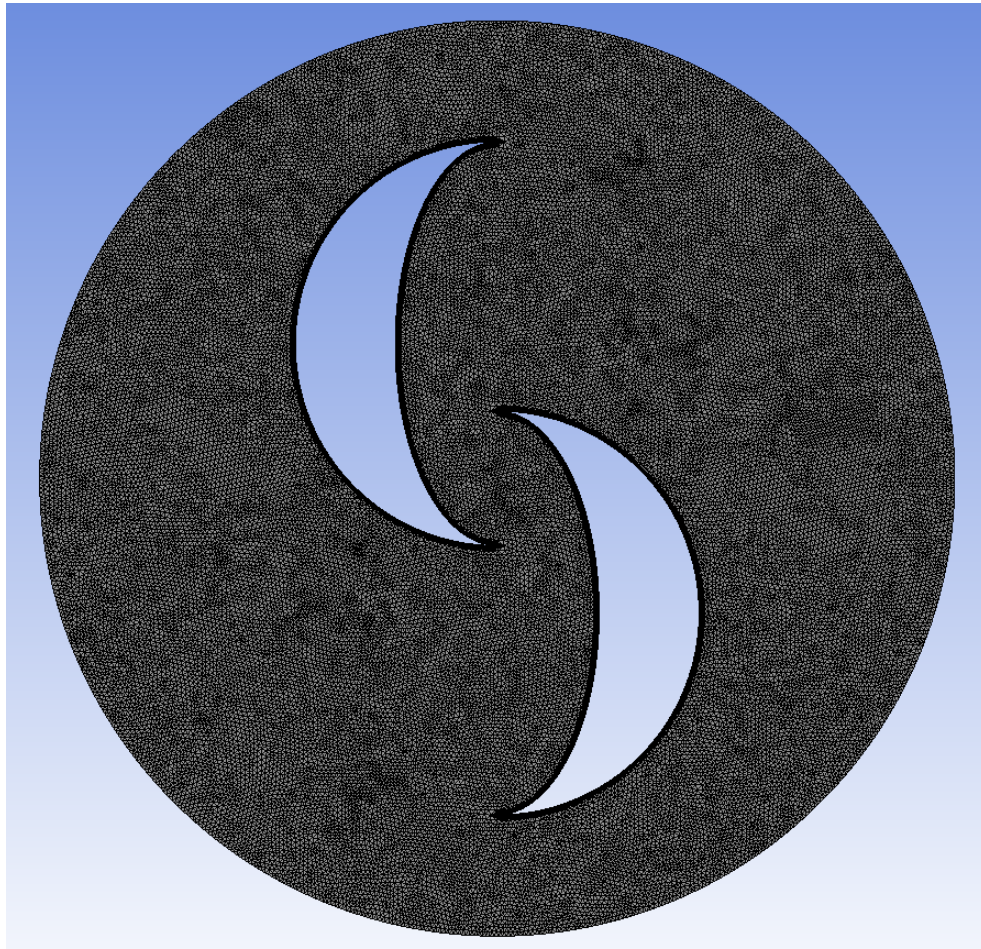
Slika 4.5. Numerička mreža rotirajuće domene
