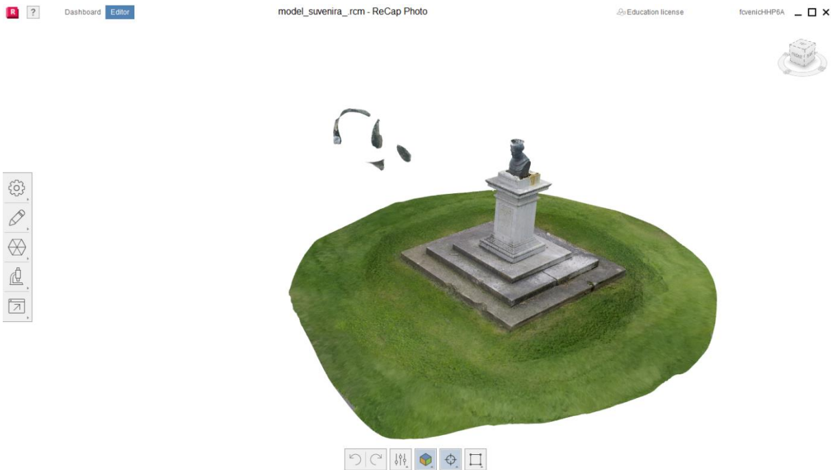
Slika 4.6 Prikaz generiranog modela s uključenom opcijom „Auto-crop“
