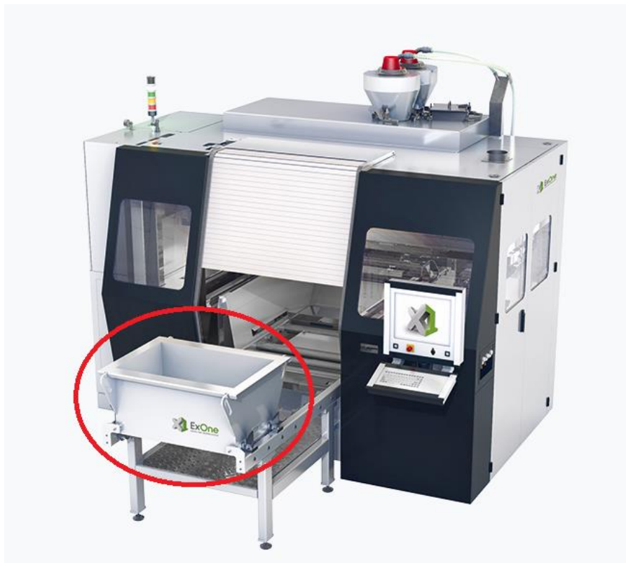
Slika 2.7 Prikaz komore predmeta uređaja ExOne S-Print [2]
