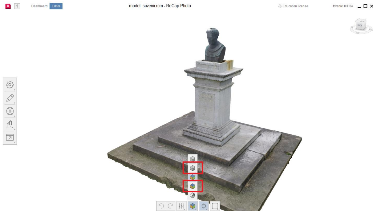
Slika 4.17 Prikaz promjene izgleda modela (gornje – mesh prikaz, donje – teksturirani mesh prikaz)
