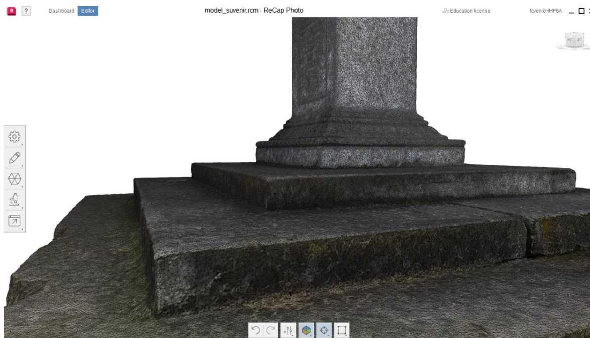
Slika 4.18 Prikaz neravnina modela (teksturirani mesh)
