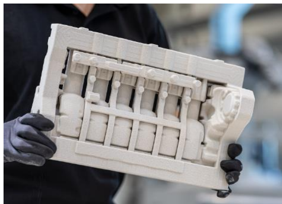
Slika 2.1 Prikaz jezgre kalupa [2]
