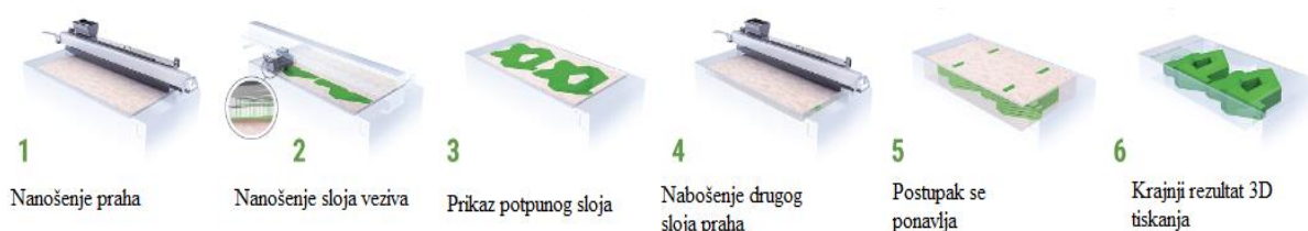
Slika 2.2 Prikaz 3D tiskanja po koracima [2]
