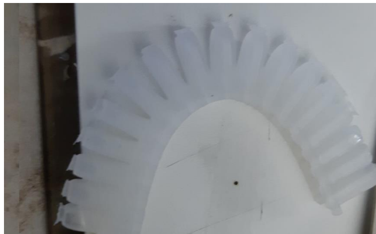
Slika 5.6. Prikaz silikona nakon vađenja iz kalupa
