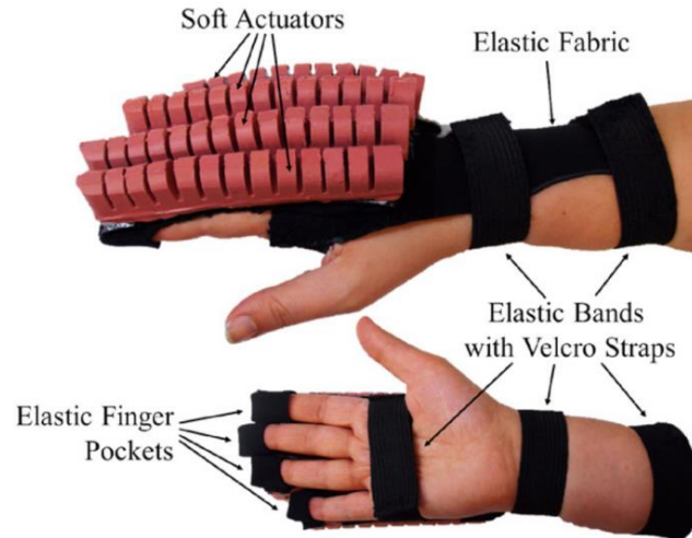
Slika 2.1. Gornji i donji pogled na prototip koji prikazuje mekane pokretače i konfiguraciju rukavice s otvorenim dlanom s čičak trakama [5]
