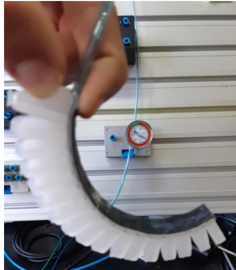
Slika 6.1. Ispitivanje prototipa A pri 0.2 bara
