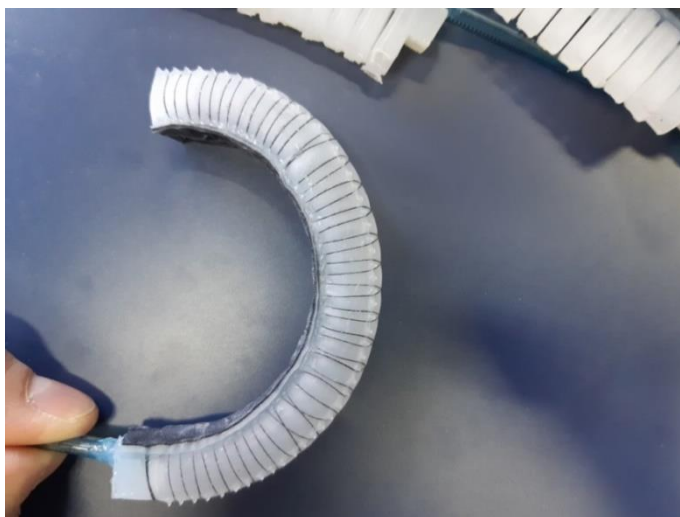
Slika 6.7. Prototip B pri tlaku od 2.5 bara
