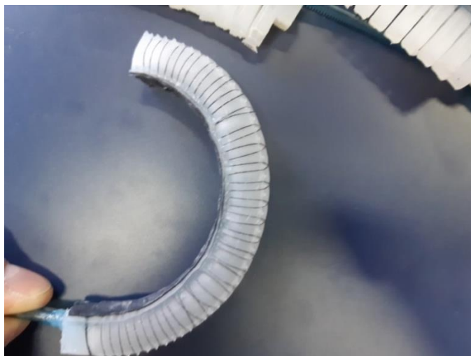
Slika 6.6. Prototip B pri tlaku od 2 bara
