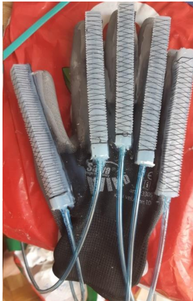
Slika 8.2. Konačni izgled prototipa rukavice za rehabilitaciju šake
