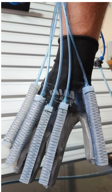
Slika 8.3. Ispitivanje rukavice: opušteni položaj
