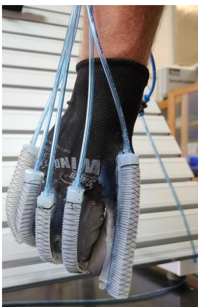
Slika 8.4. Ispitivanje rukavice: fleksija 4 prsta (bez palca)
