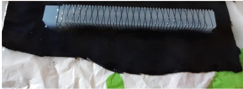
Slika 5.16. Lijepljenje pamučne tkanine na prototip B
