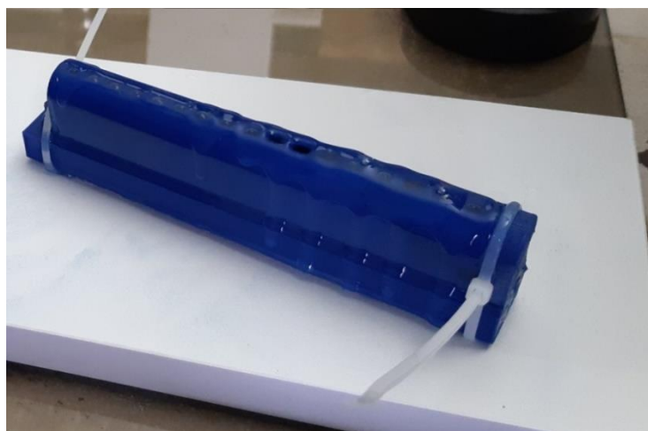
Slika 5.5. Lijevanje silikona u kalupe (Prototip A)
