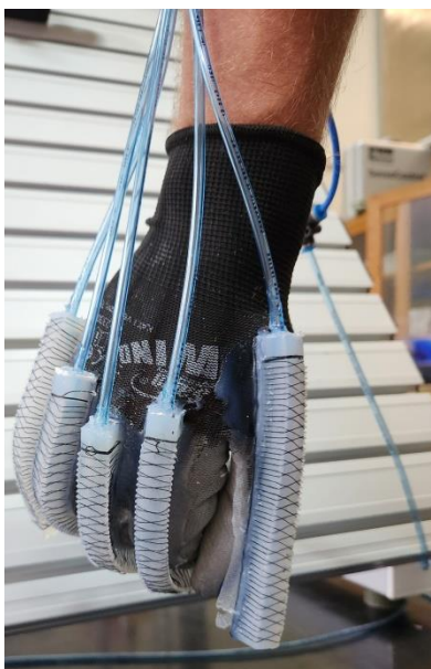
Slika 8.4. Ispitivanje rukavice: fleksija 4 prsta (bez palca)
