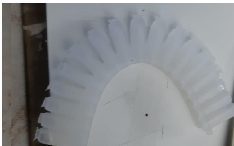
Slika 5.6. Prikaz silikona nakon vađenja iz kalupa
