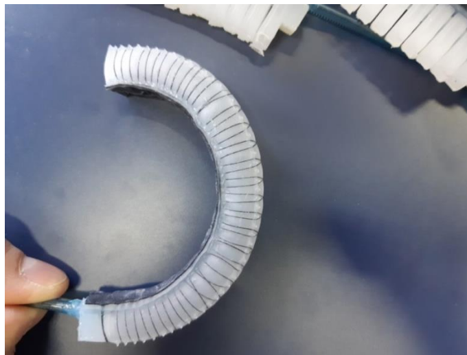
Slika 6.7. Prototip B pri tlaku od 2.5 bara
