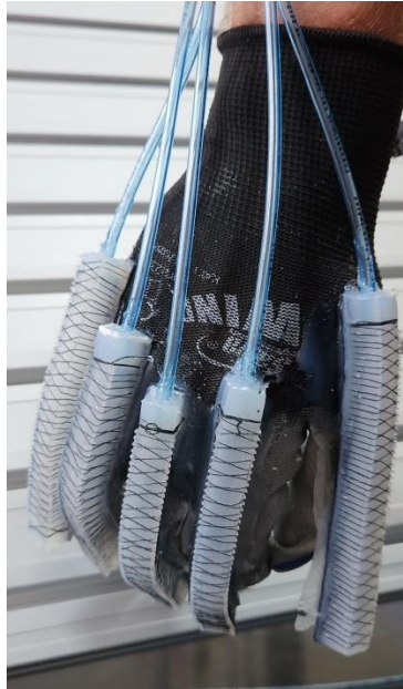
Slika 8.5. Ispitivanje rukavice: fleksija 3 srednja prsta
