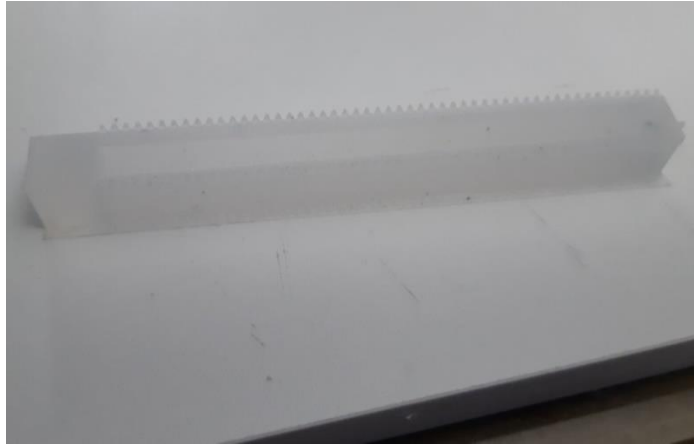
Slika 5.14. Izgled prototipa B nakon rastavljanja kalupa
