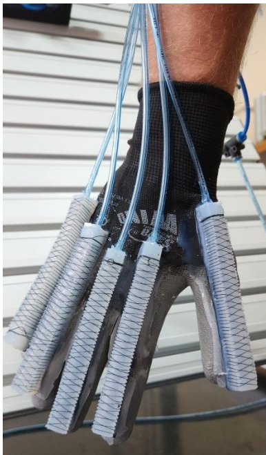
Slika 8.3. Ispitivanje rukavice: opušteni položaj
