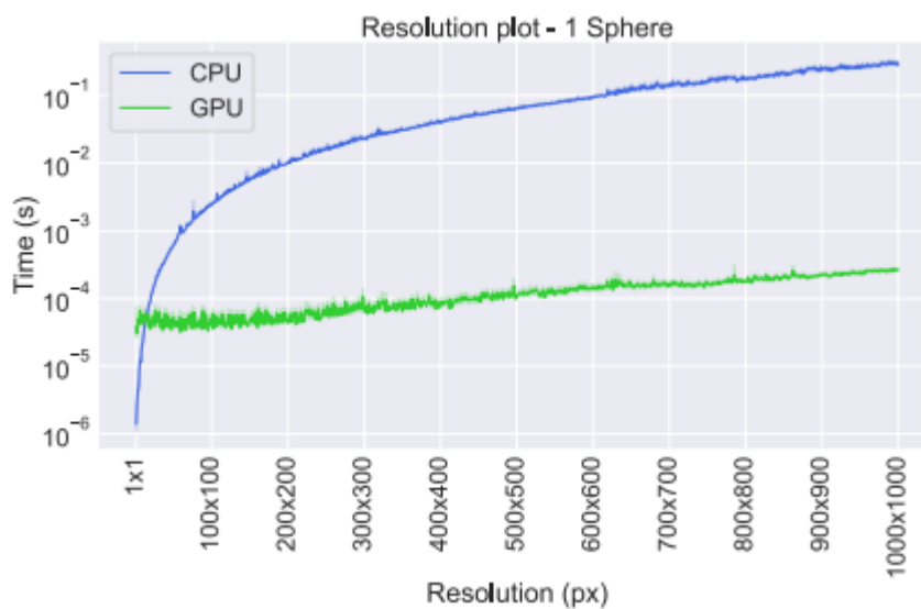
Slika 16.2 CPU vs GPU za veće rezolucije [20]
