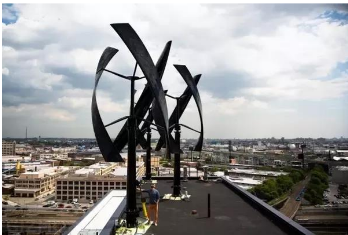
Slika 4.5. Prikaz VAWT krovne vjetroturbine tipa „darrieus“ [30]
