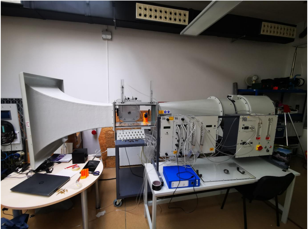
Slika 32: Aerotunel AF1300S korišten za testiranje modela lopatica
