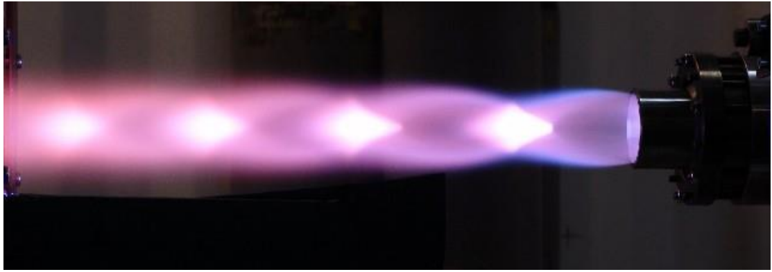
Slika 7: Machovi dijamanti koji nastaju izlazom mlaza pod tlakom koji je manji od atmosferskog
