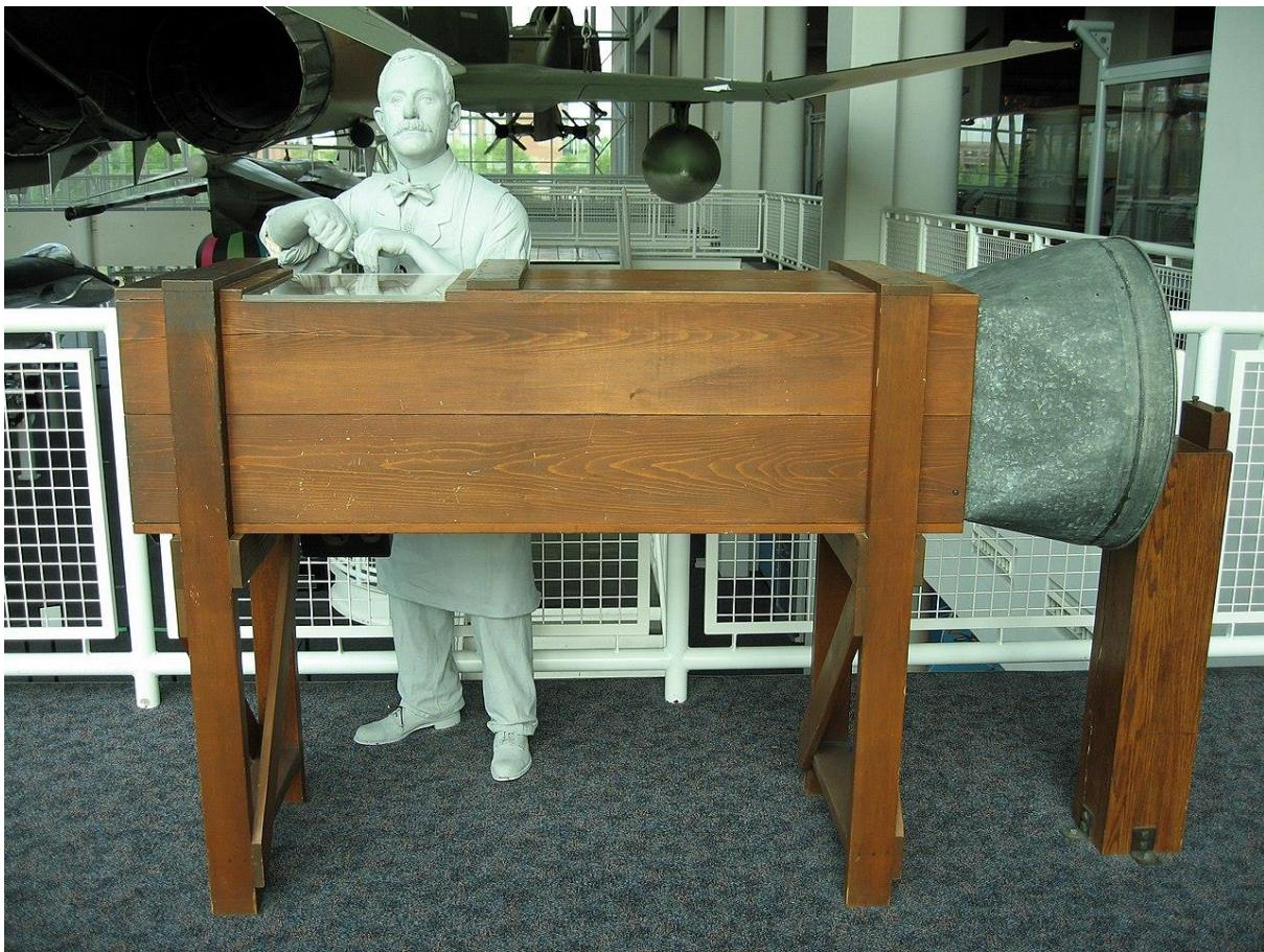
*Slika 29: Replika jednostavnog aerotunela braće Wright*
