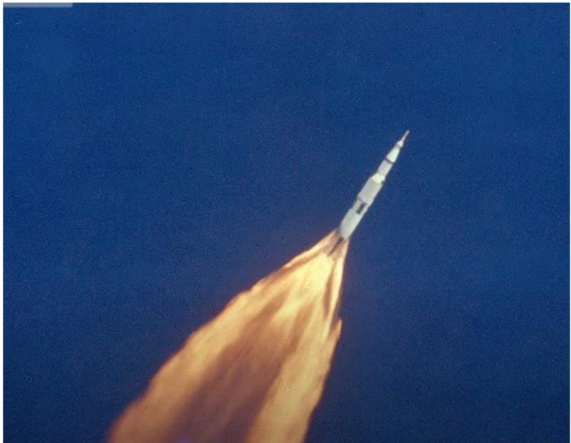
Slika 8: Testni let Apolla 6 (1968) kojem se mlaz širi jer je izlazni tlak fluida veći od atmosferskog
