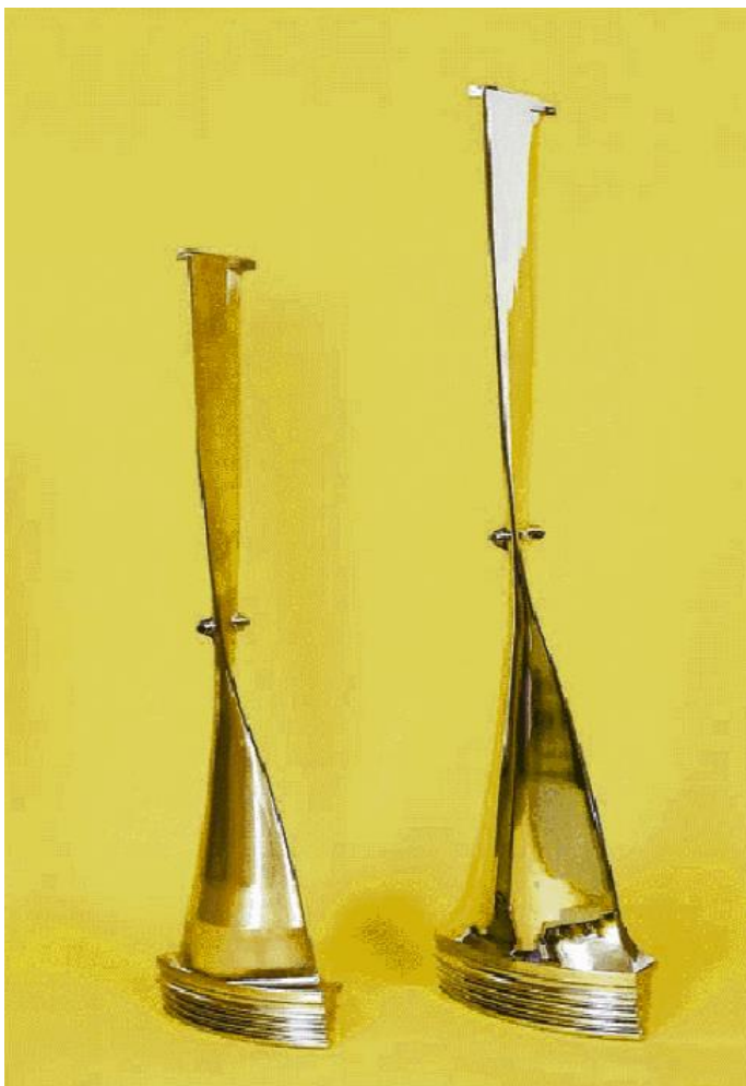
Slika 24: Duge turbinske lopatice uvijenih listova
