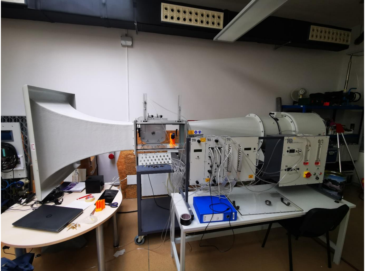
Slika 32: Aerotunel AF1300S korišten za testiranje modela lopatica
