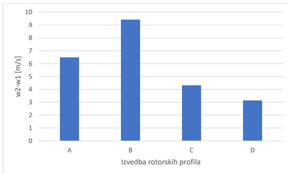
Slika 59: Intenzitet povećanja relativne brzine na testiranim rotorskim kaskadama
