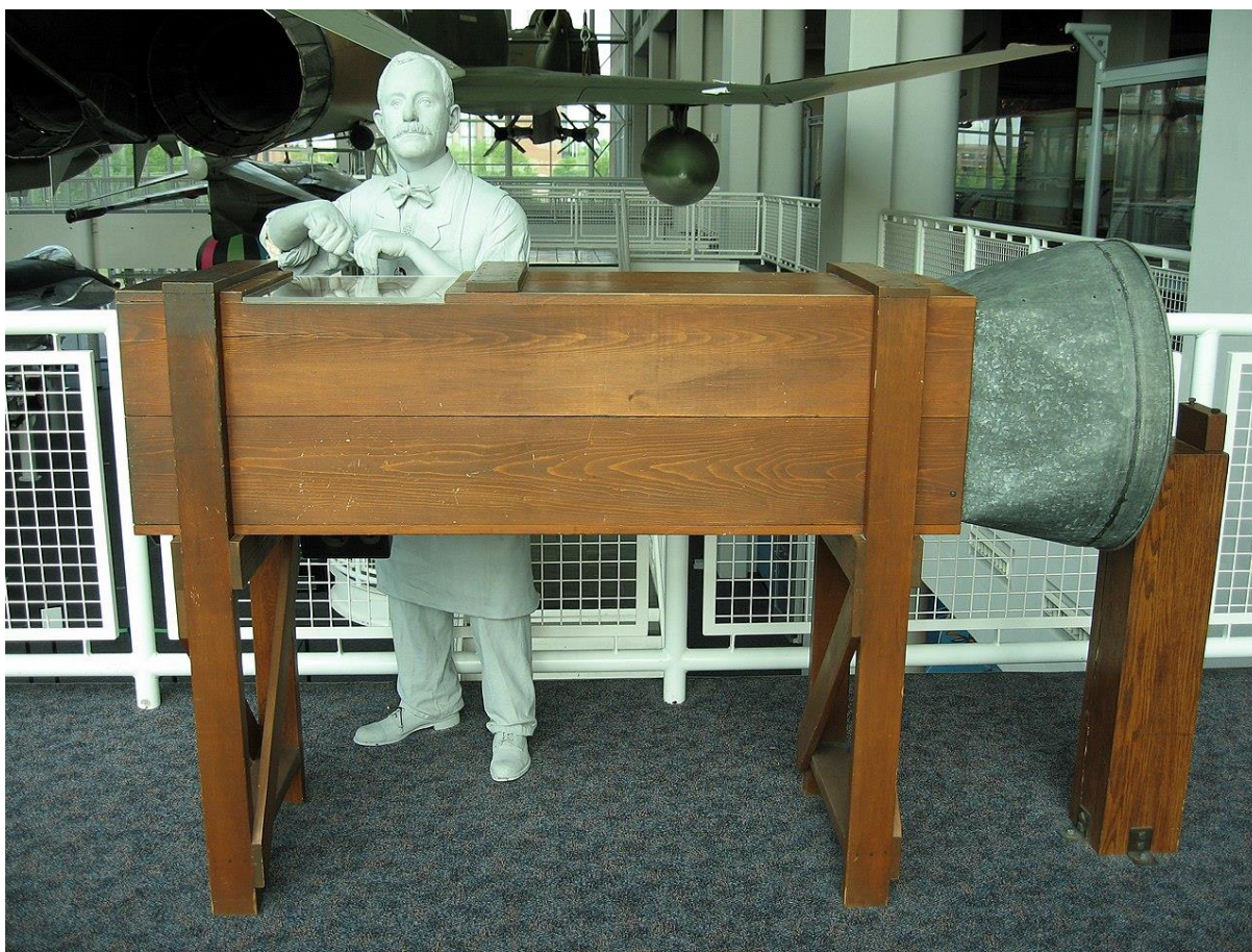
Slika 29: Replika jednostavnog aerotunela braće Wright
