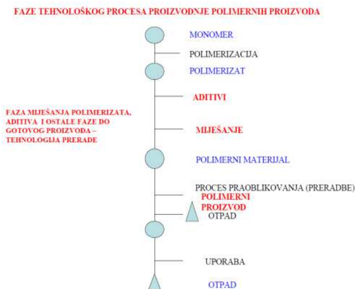
Slika 2.2. Faze tehnološkog procesa proizvodnje polimernih proizvoda [2]
