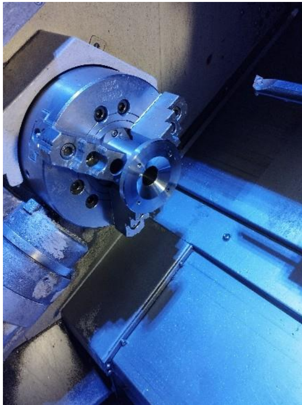
Slika 4.5. Izrada kućišta uređaja na tokarilici
