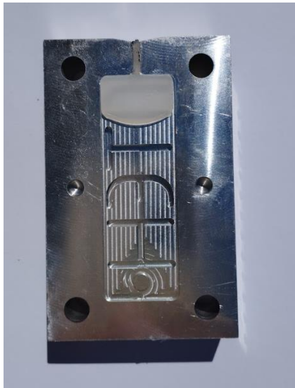
Slika 6.2. Izgled nakon otvaranja kalupa (TEST 3)
