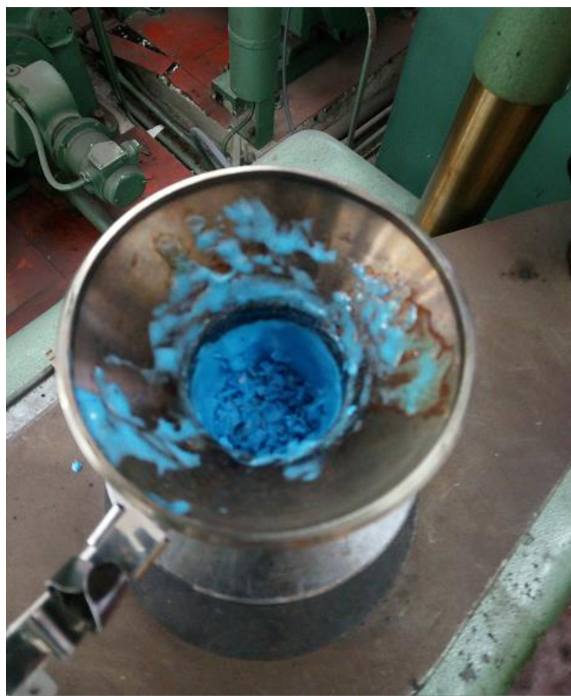
Slika 3.2. Nerastaljeni polimer unutar komore
