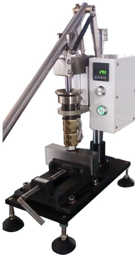
Slika 2.7. Uređaj za brizganje plastike ("uradi sam" tehnika)
