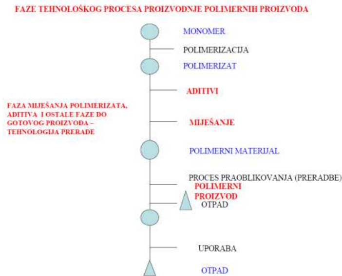
Slika 2.2. Faze tehnološkog procesa proizvodnje polimernih proizvoda [2]
