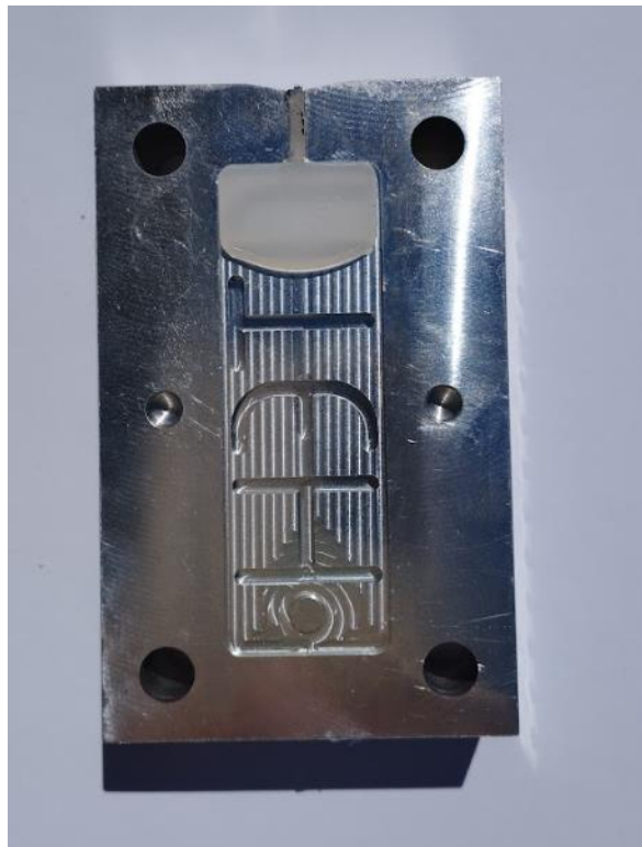
Slika 6.2. Izgled nakon otvaranja kalupa (TEST 3)
