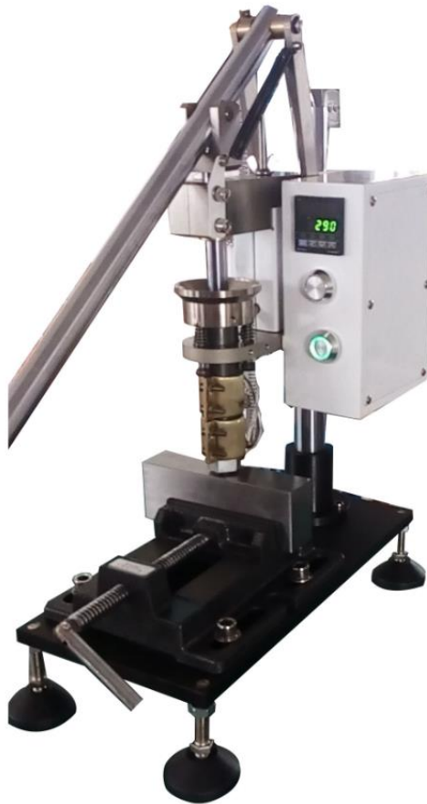
Slika 2.7. Uređaj za brizganje plastike ("uradi sam" tehnika)
