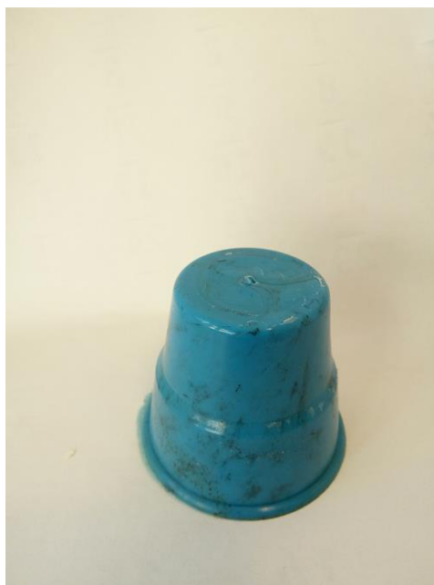
Slika 3.3. Odpresak s crnim uključcima
