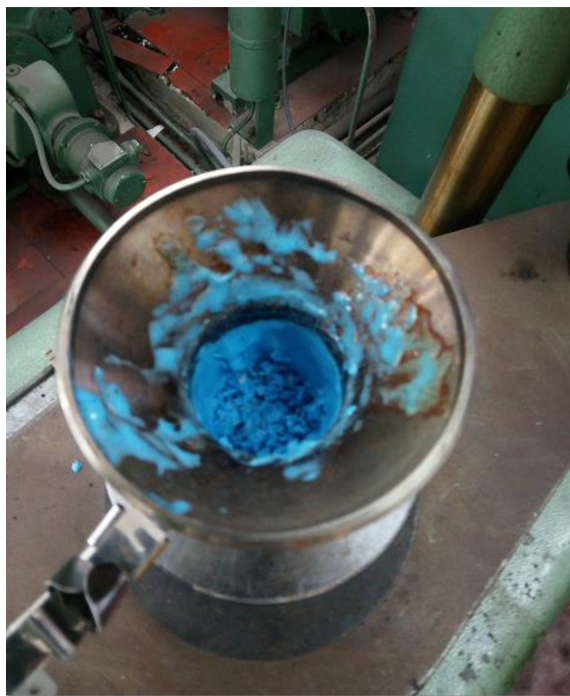
Slika 3.2. Nerastaljeni polimer unutar komore
