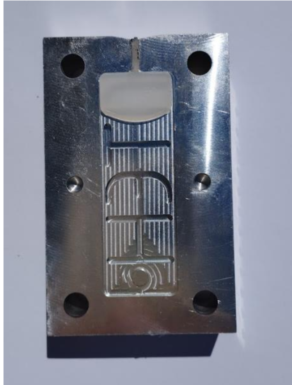
Slika 6.2. Izgled nakon otvaranja kalupa (TEST 3)
