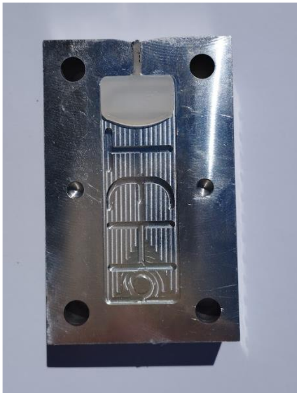
Slika 6.2. Izgled nakon otvaranja kalupa (TEST 3)
