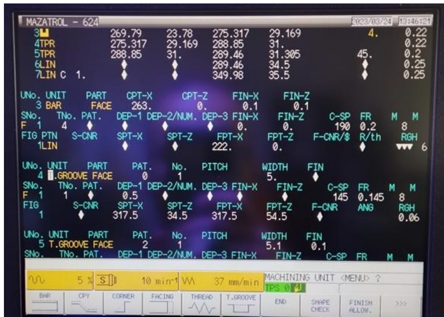
Slika 4.2. Primjer izgleda programa na Mazak CNC-tokarilici
