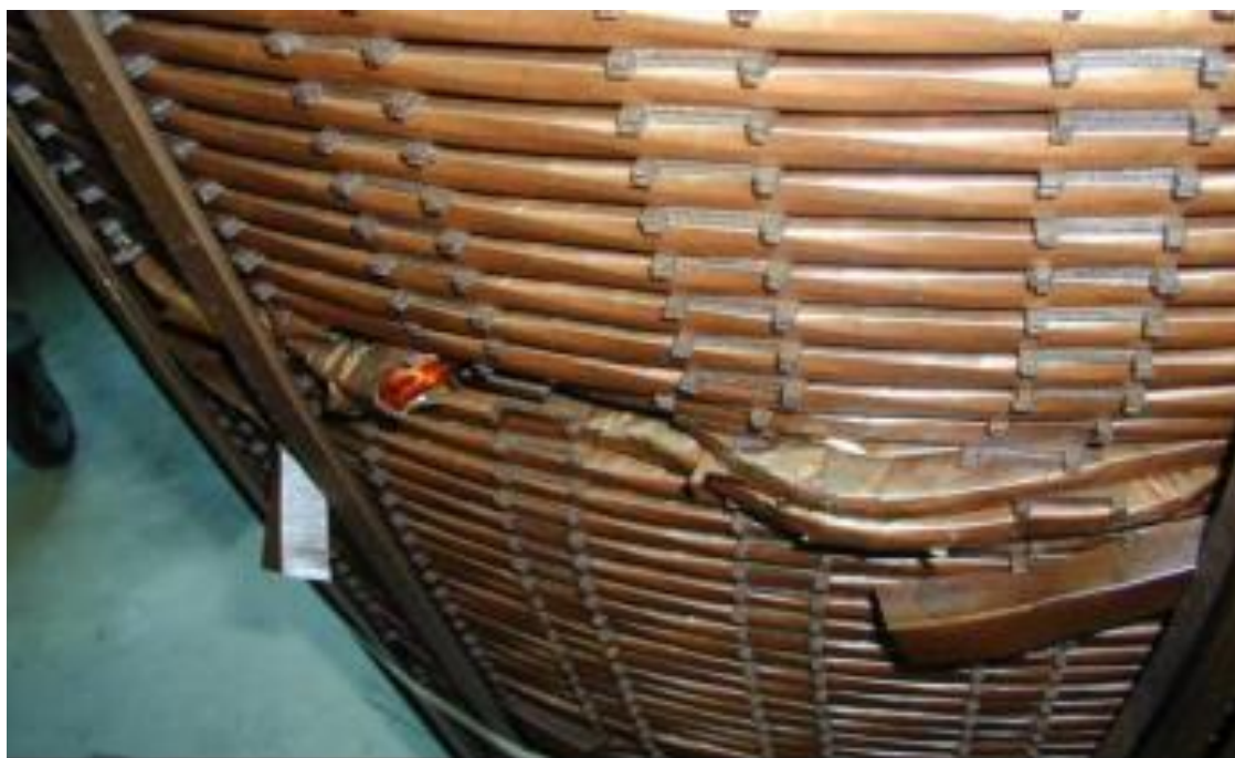
Slika 5.1. Prikaz deformacije namota
